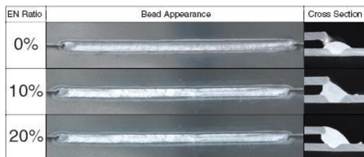
Slika 10. Utjecaj balansa negativnog polariteta na oblik zavora i geometriju spoja
