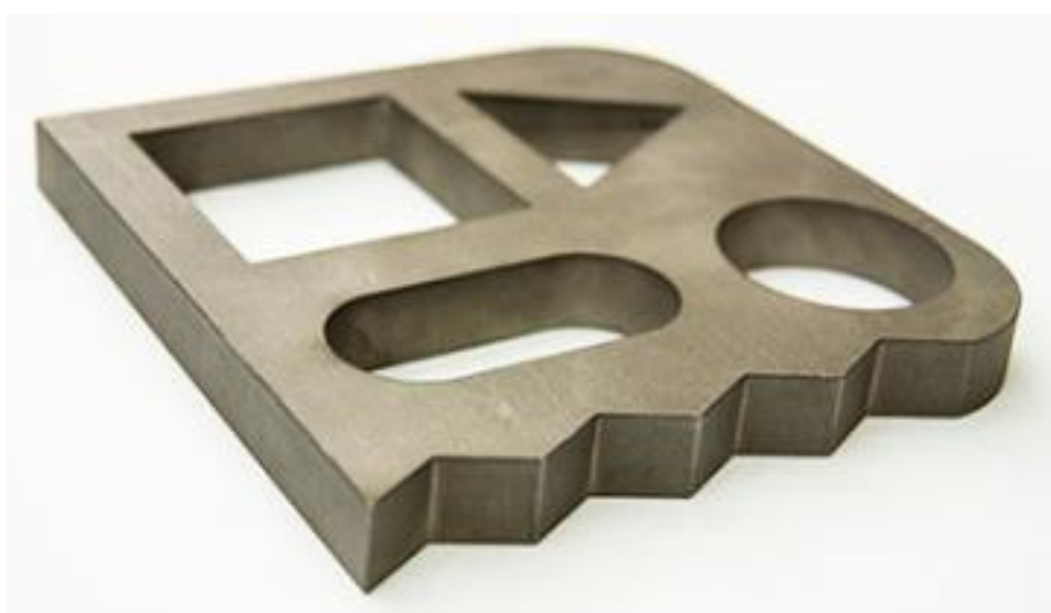
Slika 33. Element izrezan abrazivnim vodenim mlazom
