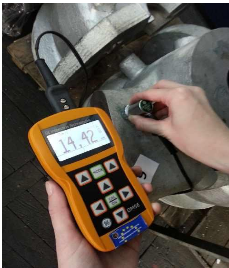
Slika 27. Mjerenje debljine stijenke odljevka ultrazvučnim uređajem.
