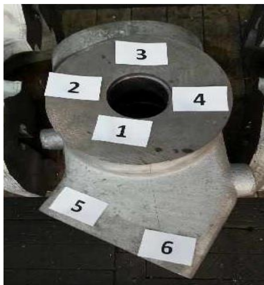
Slika 25. Označena mjesta na odljevku od čeličnog lijeva na kojima će se vršiti mjerenja.
