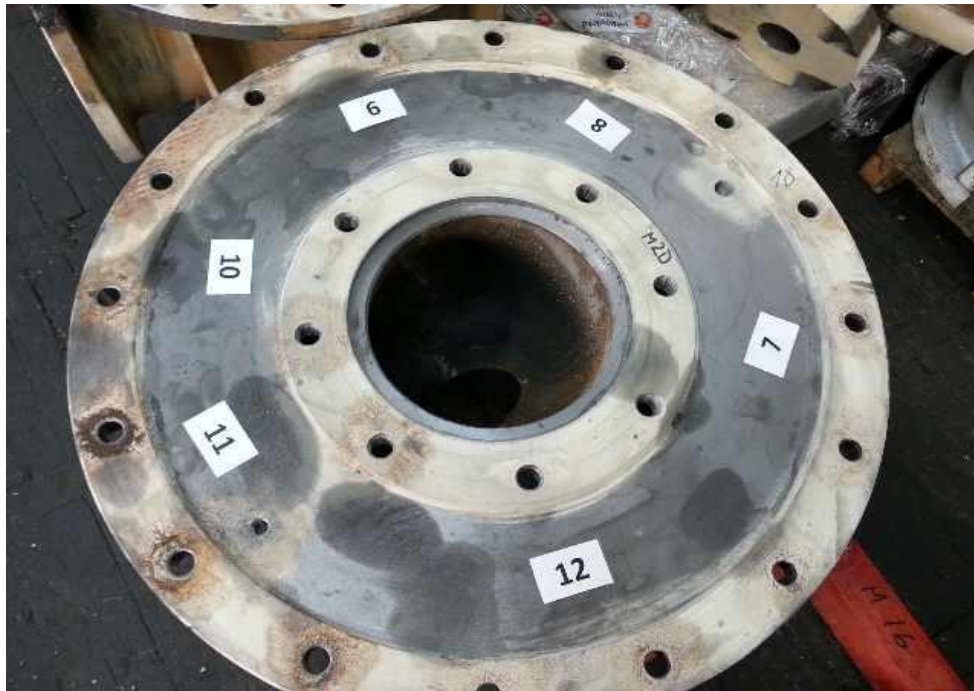
Slika 26. Odljevak od sivog lijeva očišćen, sa nanešenim gelom na površini i označenim mjestima mjerenja.
