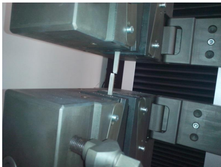
Slika 22. Epruveta nakon loma
