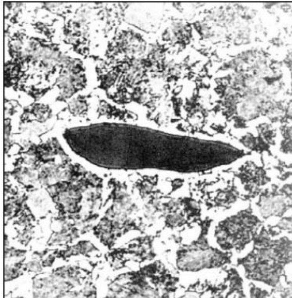
Slika 11. Sulfidni uključak (MnS) u čeliku sa 0,35% C [8]
