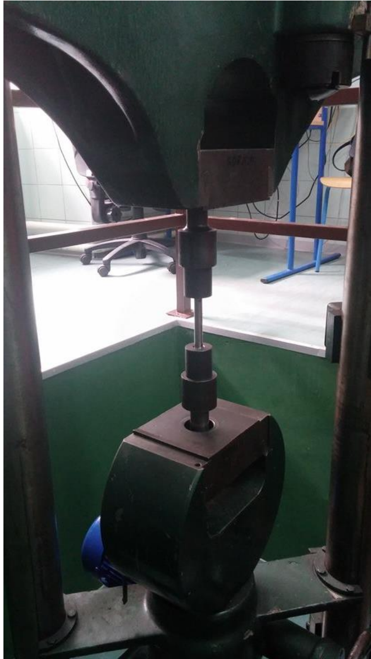
Slika 26. Učvršćena probna epruveta
