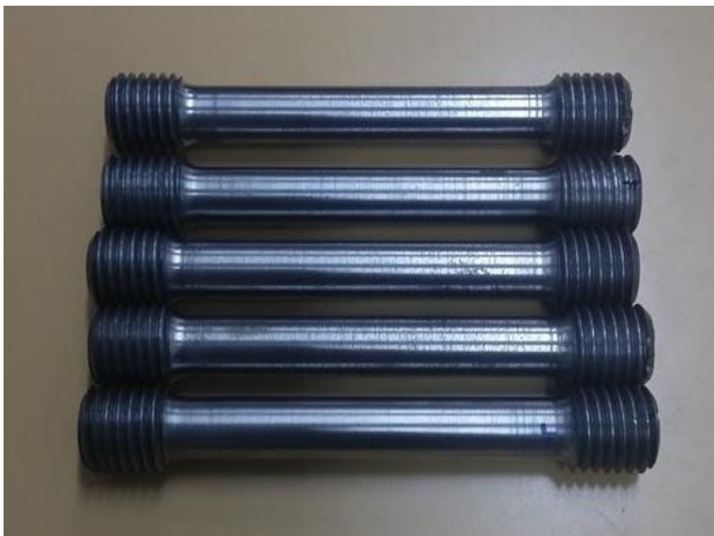
Slika 22. Epruvete za ispitivanje vlačne čvrstoće
