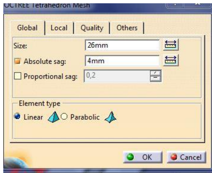
Slika 52. Linearni tetraedarski konačni element
