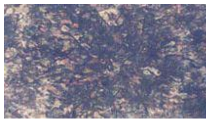
Perlitna osnova, povećanje 100X
