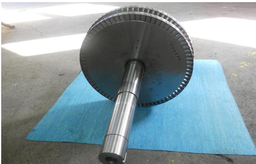
Slika 1. gotova rotorska kola (rotor I, rotor II) montirana na vratilo
