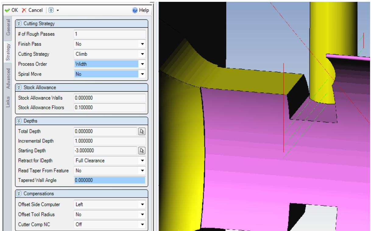
Slika 44. prikazuje grubu obradu kanala vrata T-noge lopatice
