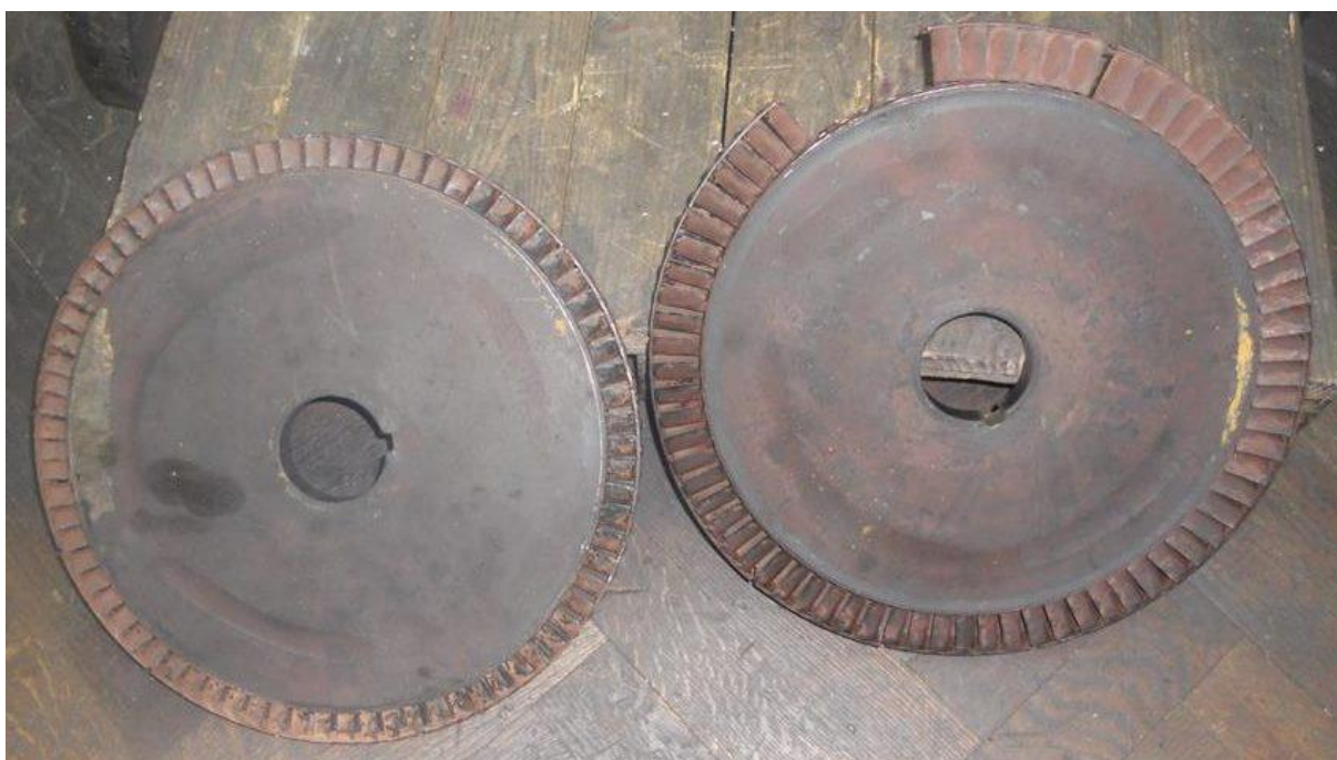
Slika 6. prikazuje manje i veće rotorsko kolo Curtis-turbine
