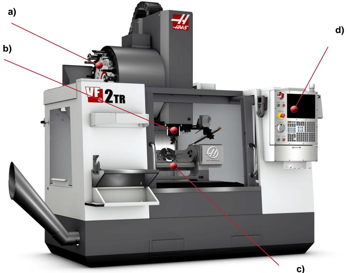
Slika 23. HAAS VF-2TR – a) standardni rotacioni izmjenjivač alata, b) vreteno, c) trunnion,
