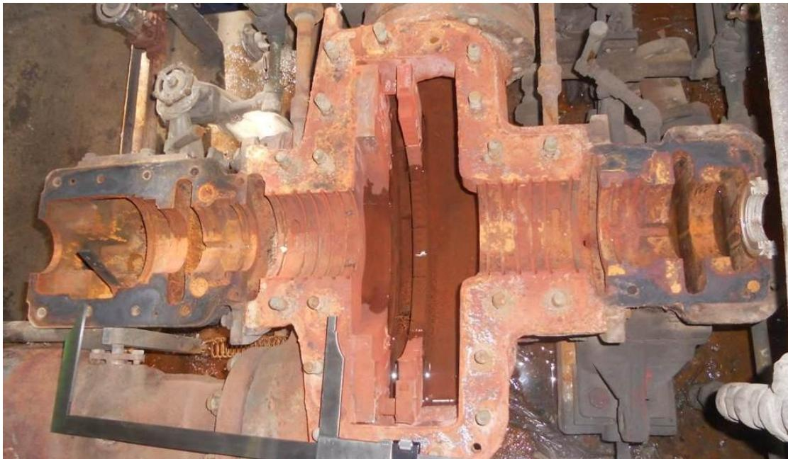
Slika 4. prikazuje donji dio kućišta bez rotora turbine
