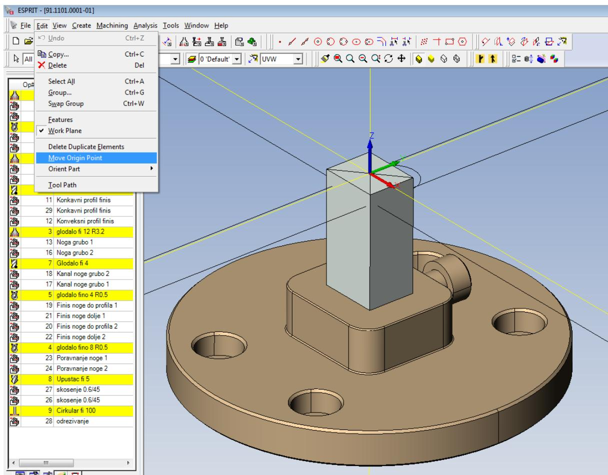
Slika 29. prikazuje 3D modele stezne naprave i sirovca
