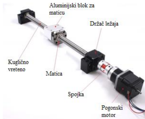
Slika 11. Građa pogona na kuglično vreteno
