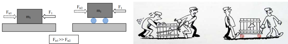
Slika 13. Prikaz razlike trenja kotrljanja i trenja klizanja
