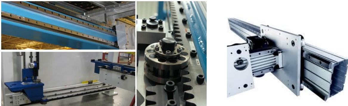
Slika 7. Primjer linearnog pogona sa zupčanikom i zubnom letvom
