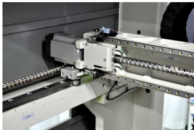
Slika 12. Primjer pogona na kuglično vreteno
