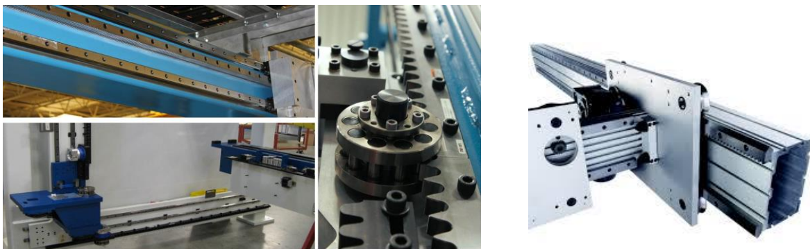
Slika 7. Primjer linearnog pogona sa zupčanicom i zubnom letvom
