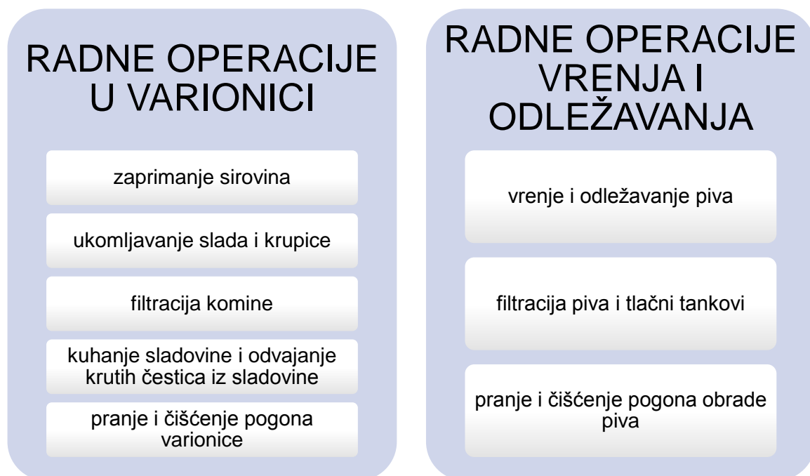
Slika 1: Tehnološki procesi u prvoj fazi procesa proizvodnje piva
