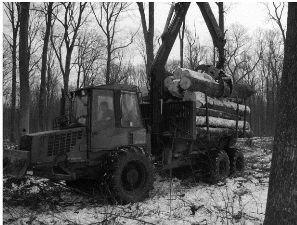
Slika 16. Istraživani forvarder Valmet 840.2 u radu [13]
