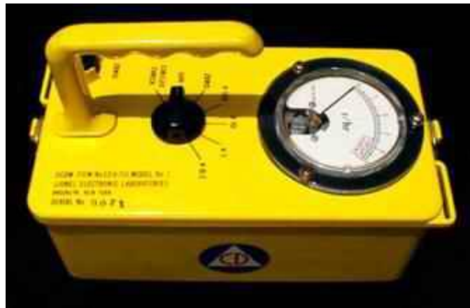
SI.13. uređaj za mjerenje kontaminiranosti
