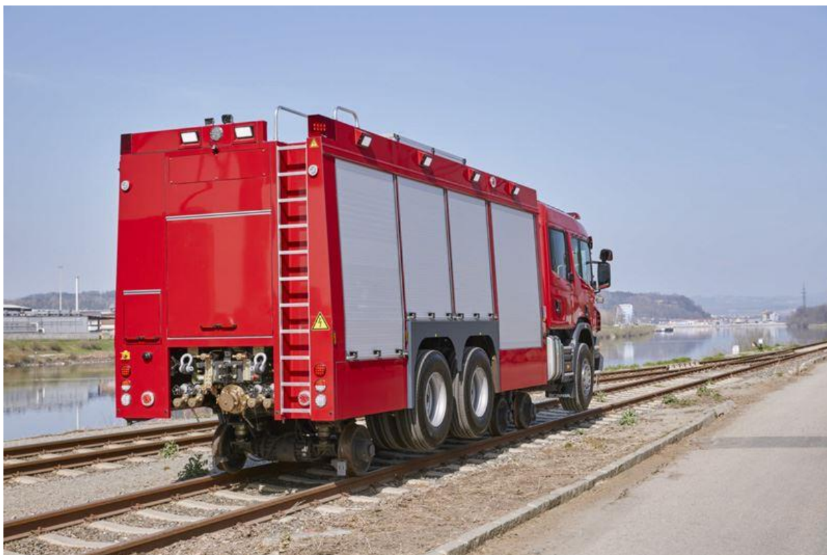
Sl. 14. Vatrogasni kamion ZW RLF-T 3000/100/100 rail sa stražnje strane [27]
