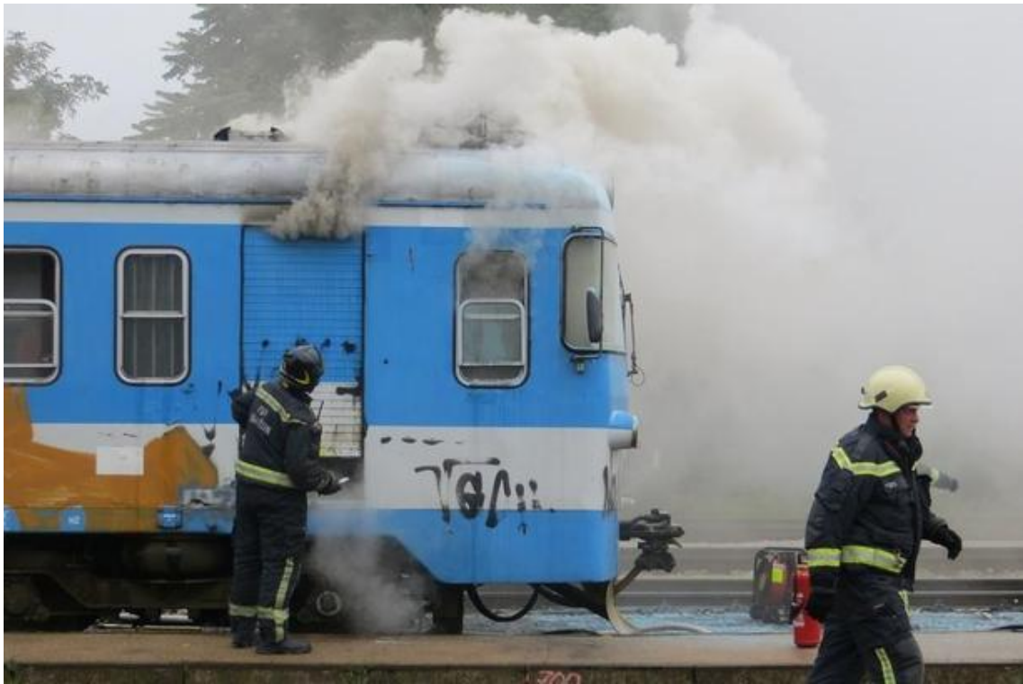
Sl. 10. Otvaranje kućišta motora zapaljenog vlaka [21]
