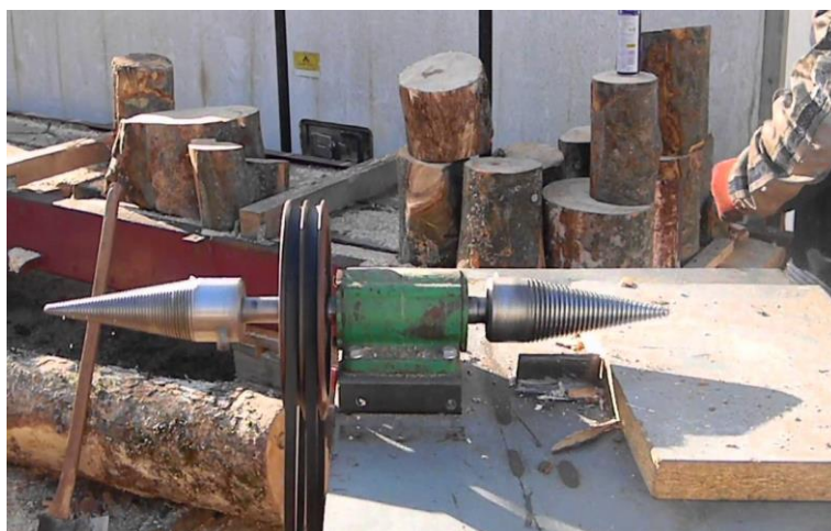
Slika 10. Obostrani električni cjepač za drva sa svrdlom.
