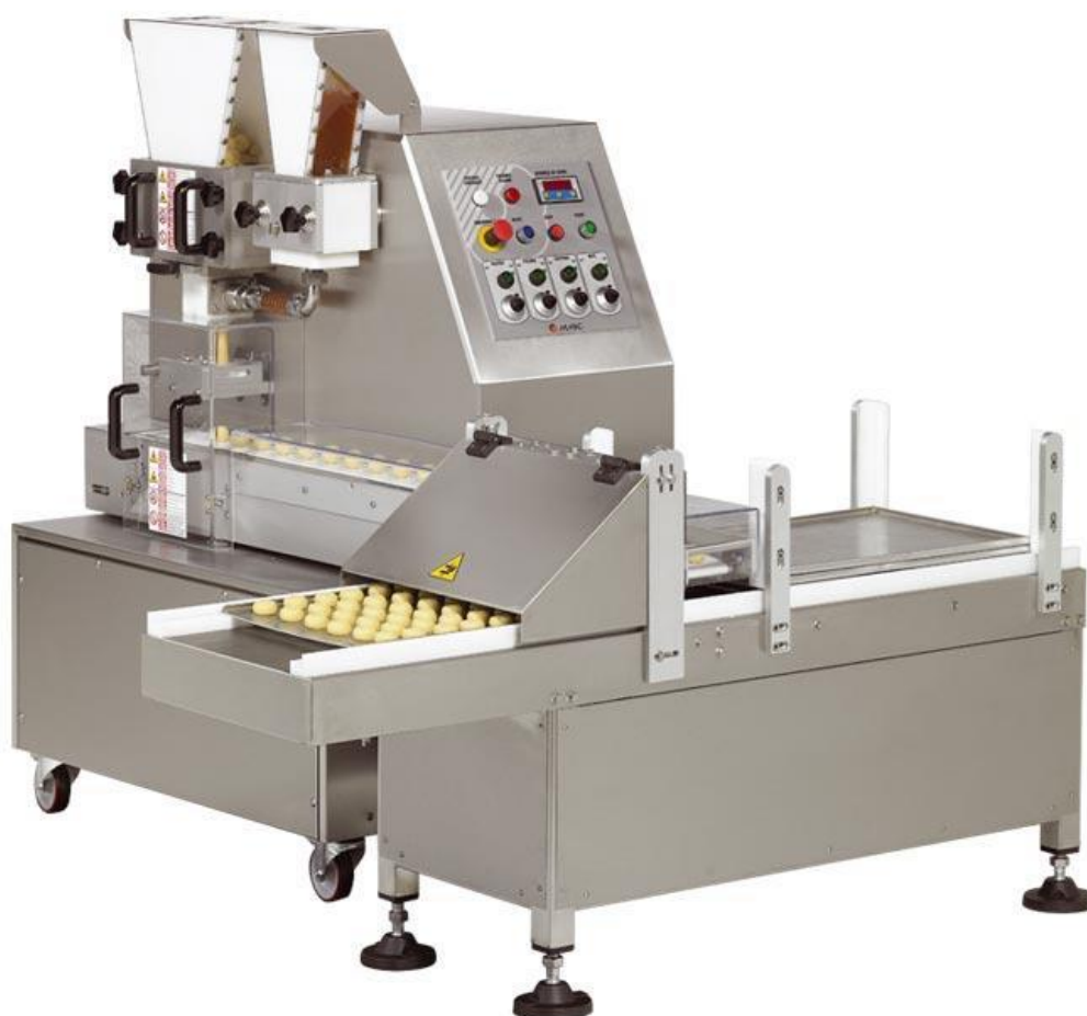
Slika 7. Zaštita opasnih mjesta na stroju zaštitnim poklopcima.[16 ]
