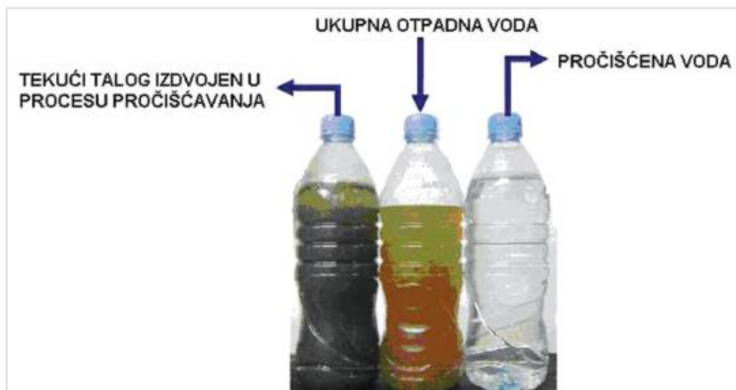
Slika 2. Pročišćavanje otpadne vode
