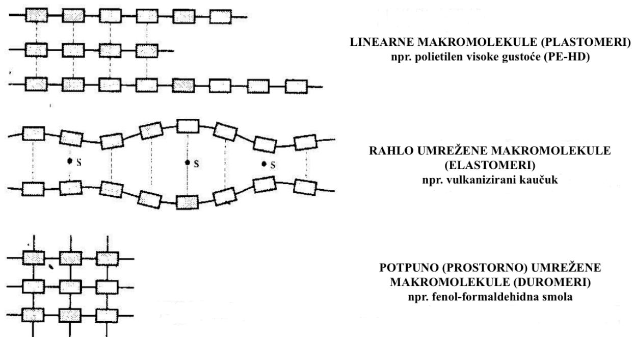
Slika 1. Shematski prikaz makromolekulne strukture osnovnih skupina polimernih materijala [1]
