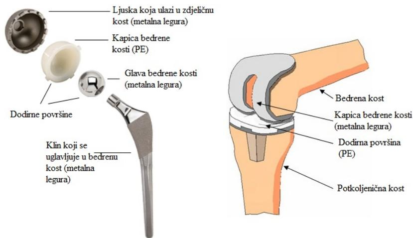
Slika 13. Dijelovi umjetnog kuka [31] i koljena [32]
