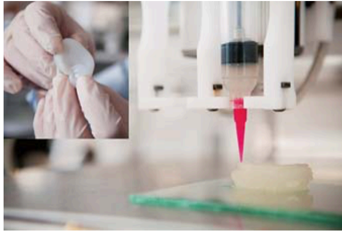
Slika 32. Izrada umjetnog uha [44]
