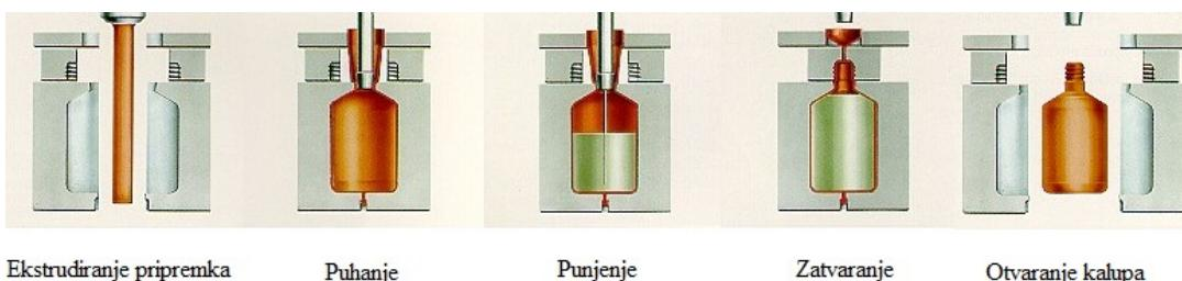
Slika 9. Postupak kombiniranog ekstruzijskog puhanja i punjenja [19]
