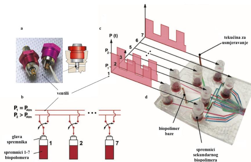
Slika 27. Shematski prikaz rada glave pisača bioprintera: a) fotografija i crtež presjeka elektromagnetskog ventila za 3D pisače (The Lee Company, US) kojeg koristi uređaj, b) prikaz rada spremnika s ventilima, c) grafički prikaz otvaranja/zatvaranja ventila u ovisnosti o promjeni tlaka i duljine vremenskog perioda, d) fotografija glave pisača sa spremnicima i kanalima za otpremu biopolimera i tekućine za usmjeravanje. [48]
