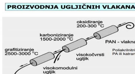
Slika 21: Prikaz postupka proizvodnje vlakana – ugljičnih [9]
