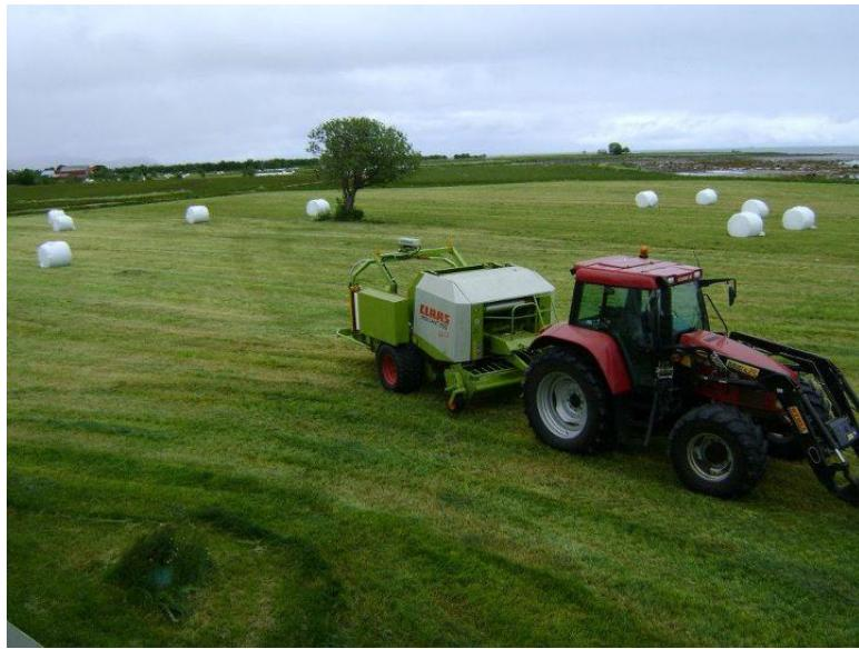
Slika 4. Proizvodnja sjenaže suvremenom mehanizacijom
