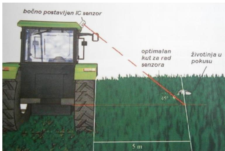
Slika 19. Primjer otkrivanja divljači pomoću bočno postavljenog IC senzora
