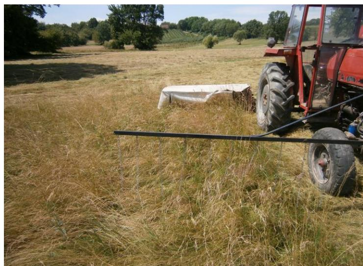
Slika 18. Postavljena plašilica od lanaca ispred rotacijske ksilice (vlastita konstrukcija)
