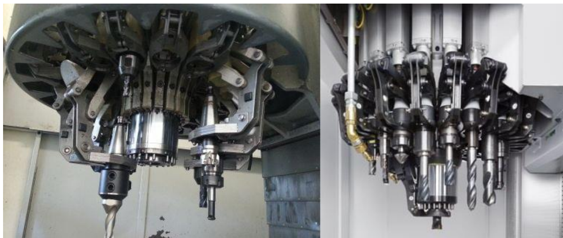
Slika 45 AIA na košarastom spremištu alata, CHIRON [19]
