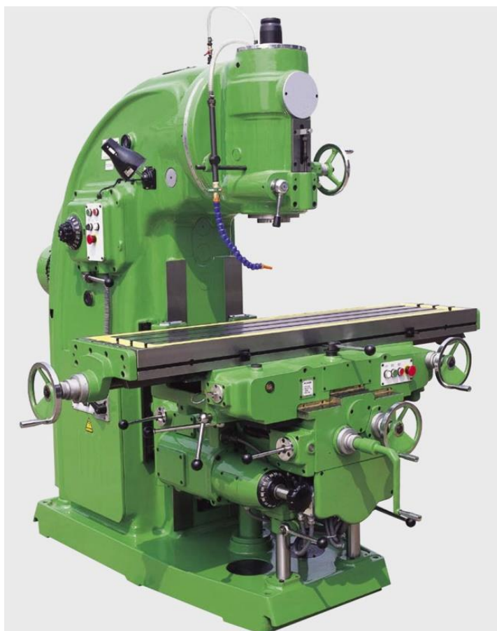
Slika 26 Konvencionalna (klasična) glodalica
