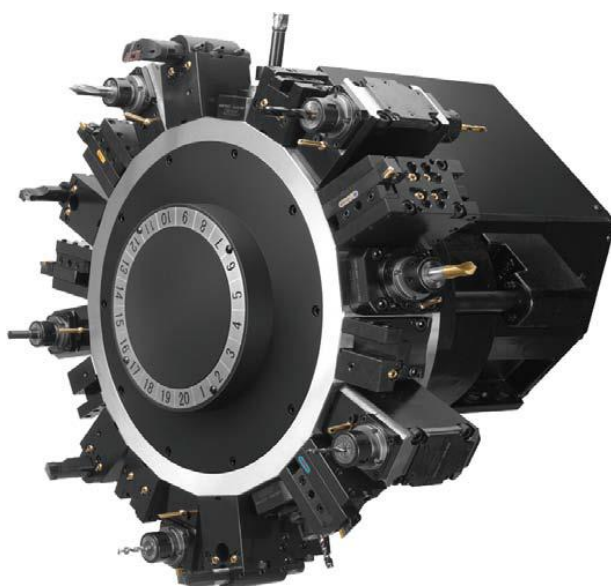
Slika 16 Revolverska glava sa 20 alata [7]
