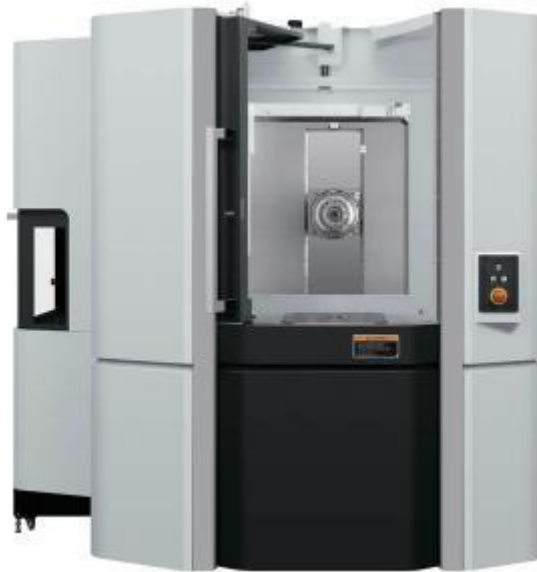
Slika 28 Horizontalni glodači obradni centar DMG MORI NHX 10000 [15]
