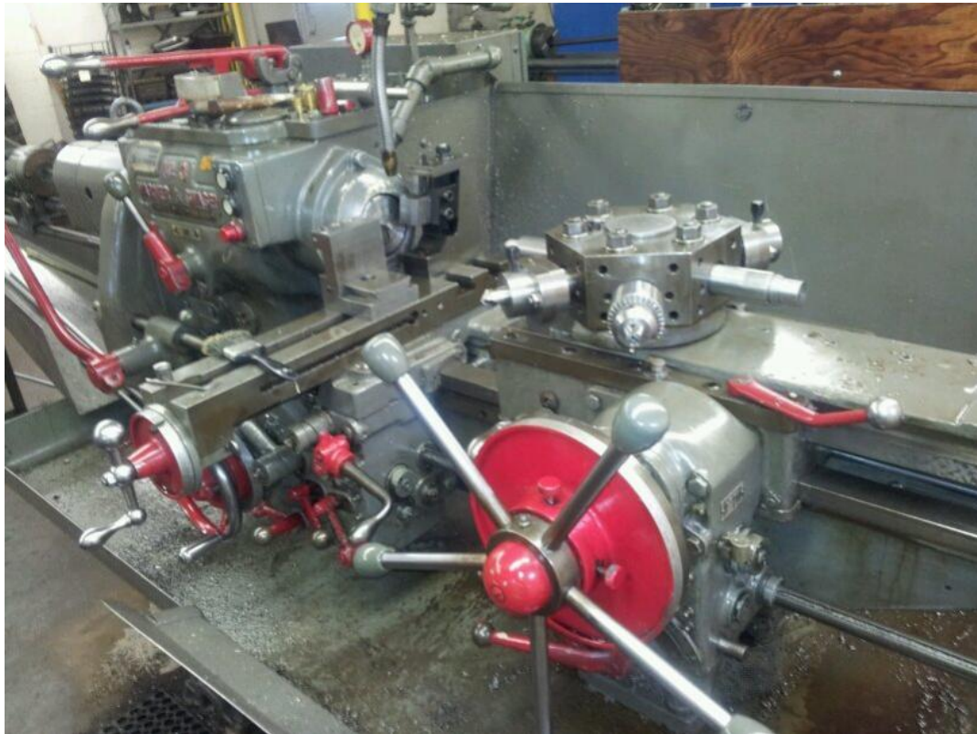
Slika 12 Revolverska glava na konvencionalnoj tokarilici
