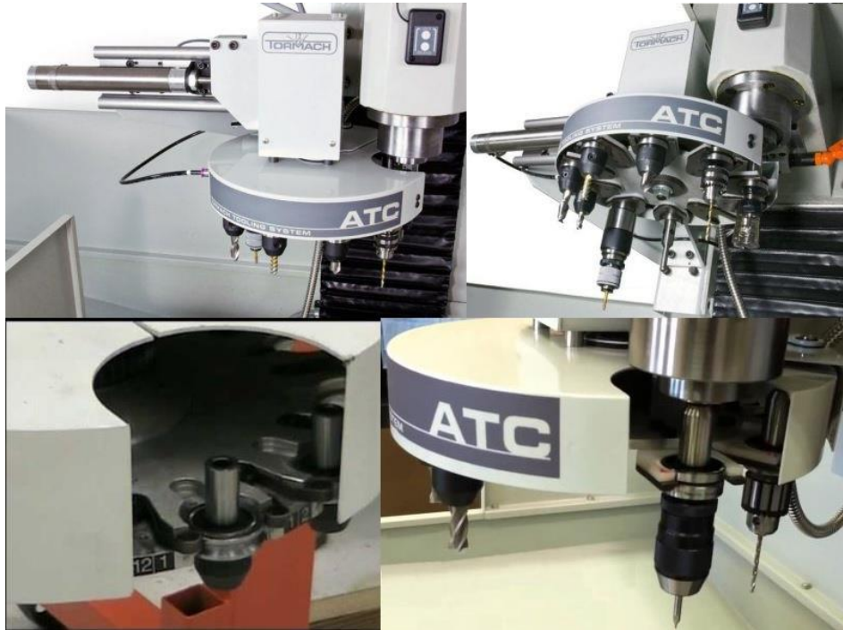
Slika 43 AIA na kružnom spremištu alata, TORMACH [17]
