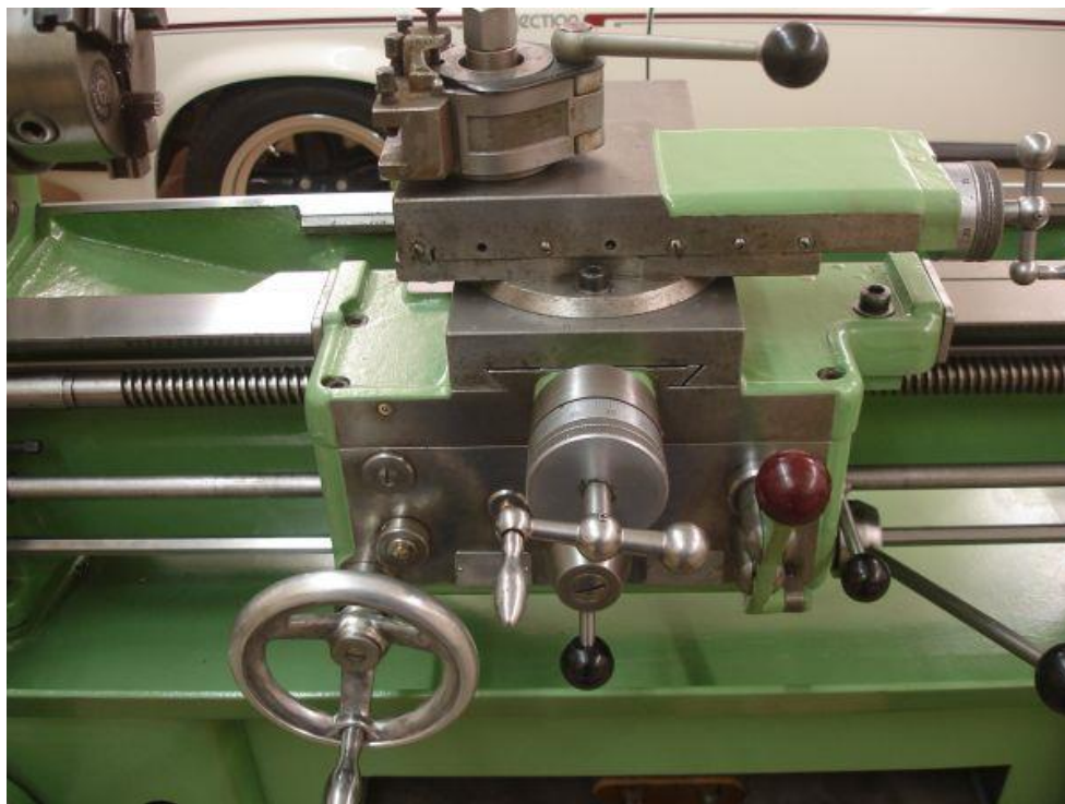
Slika 11 Prihvat alata (suport) na konvencionalnoj tokarilici [8]
