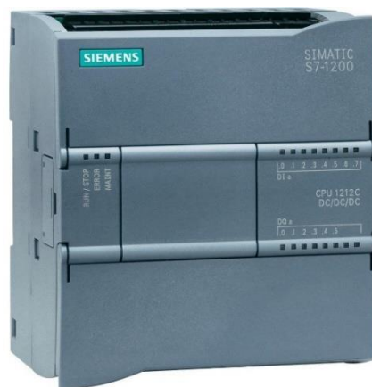
Slika 16. S7-1212 PLC / Autor slike 16: Siemens
