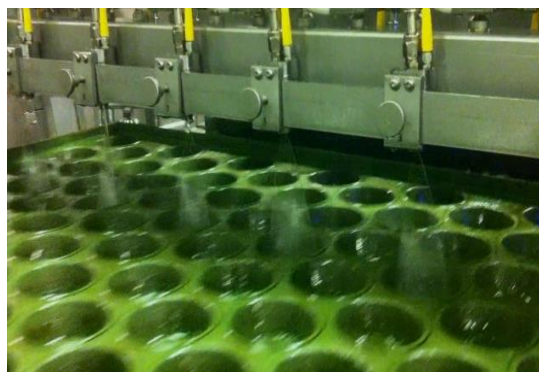
Slika 2. Nauljivanje kalupa / Autor slike 2: Spraying Systems Co.
