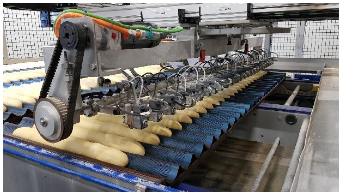
Slika 7. Vodeno narezivanje / Autor slike 7: Antun Omrčen
