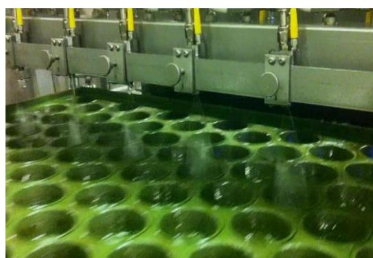
Slika 2. Nauljivanje kalupa / Autor slike 2: Spraying Systems Co.
