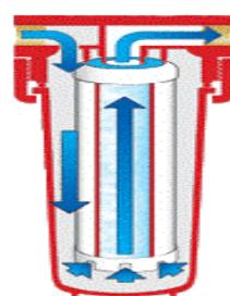
Slika 10. Princip rada filtera / Autor slike 10: Atlasfilteri
