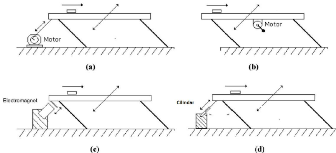
**Slika 13.** Mehanizmi uzbude vibracijskih konvejera [5]
