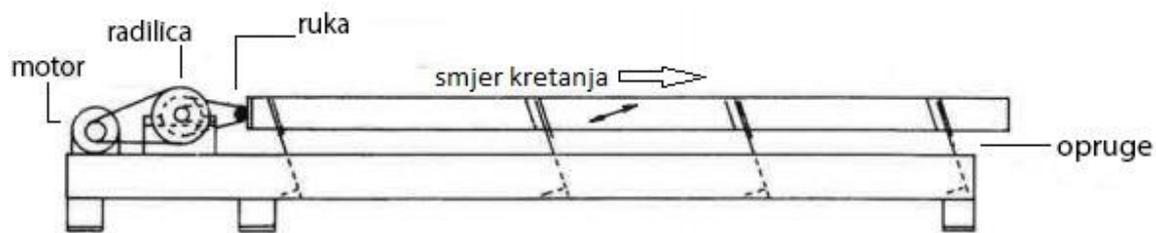
**Slika 14.** Princip rada konvejera sa klipnom uzbudom [2]
