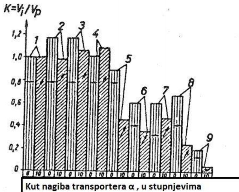
**Slika 8.** Dijagram odnosa brzine razmatranog materijala  $v_i$  prema brzini kretanja pijeska  $v_p$ , pri horizontalnom transportu ( $\alpha=0^\circ$ ) i pri transportu kosim vibracijskim transporterom ( $\alpha=10^\circ$ ); amplituda osciliranja  $a=3,5$  mm i frekvencija  $1000 \text{ min}^{-1}$ ; 1 – pijesak, 2 – sitnokomadna ruda, 3 – sitnokomadna zgura, 4 – komadni ugljen, 5 – fosforno brašno, 6 – apatit, 7 – dolomit u prahu, 8 – šamot u prahu, 9 – cement [15]
