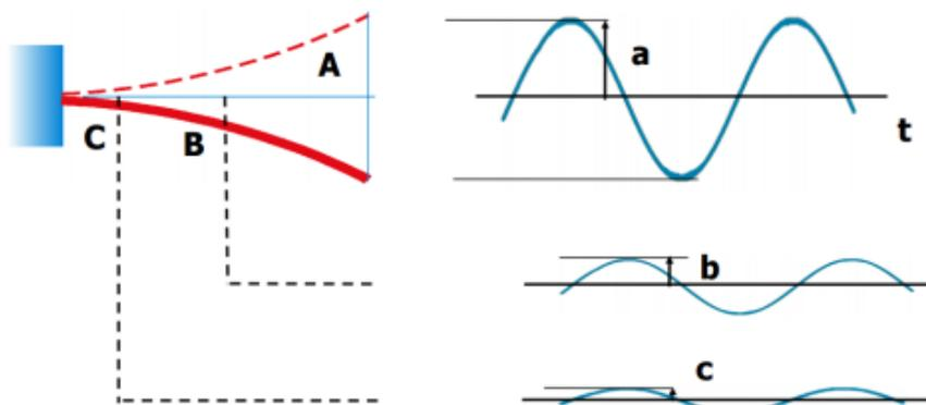
Slika 6. Amplituda vibracijskog pomaka [17]
