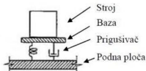
**Slika 23.** Postavljanje stroja na izoliranu bazu stroja[12]
