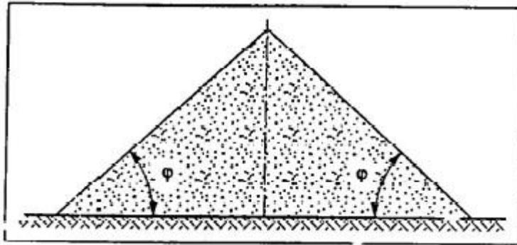
**Slika 3.** Kut prirodnog nasipavanja – nasipni kut [15]
