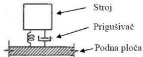
**Slika 22.** Postavljanje stroja na prigušivač [12]
