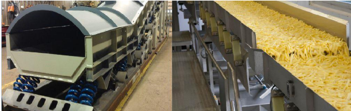
Slika 12. Zatvoreni (obli) i otvoreni (pravokutni) tip konvejera [4]
