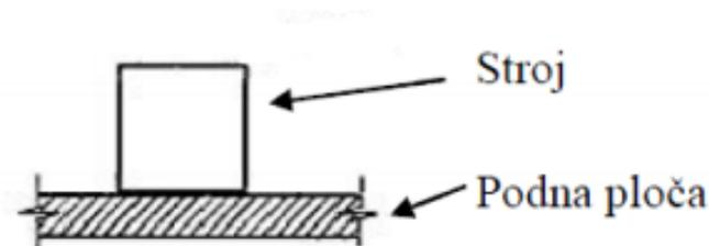
**Slika 21.** Direktno postavljanje stroja na konstrukcijski element [12]
