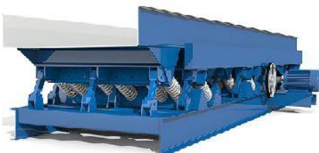
b) konvejer sa spiralnim oprugama
