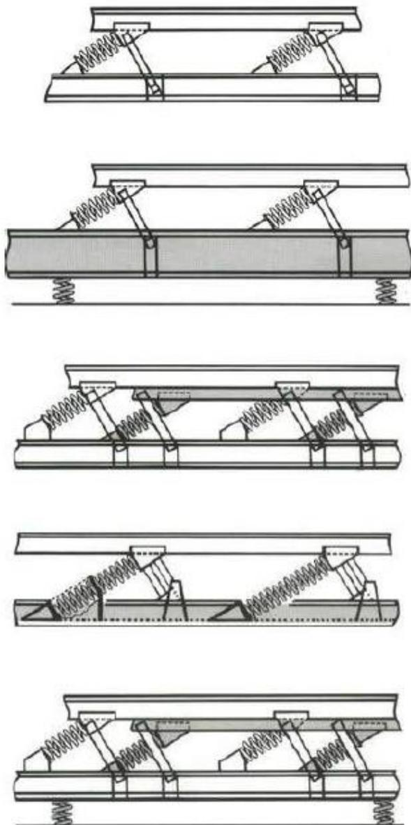
a) montirano na podlogu - cijela reakcija sustava se prenosi na podlogu
