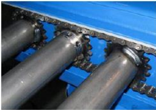
Slika 10. Prijenos vučne sile lancem
