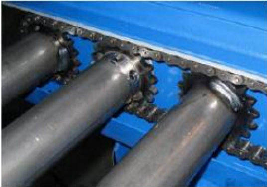
Slika 10. Prijenos vučne sile lancem
