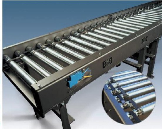
Slika 11. Prijenos vučne sile remenom
