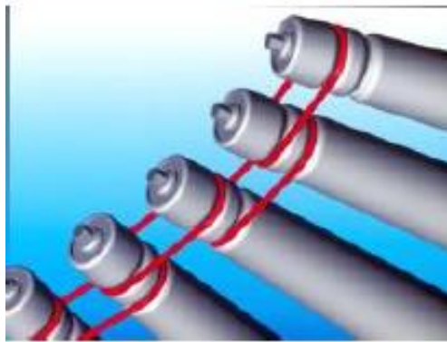
Slika 12. Prijenos vučne sile trakom
