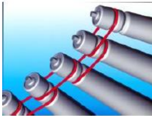
Slika 12. Prijenos vučne sile trakom
