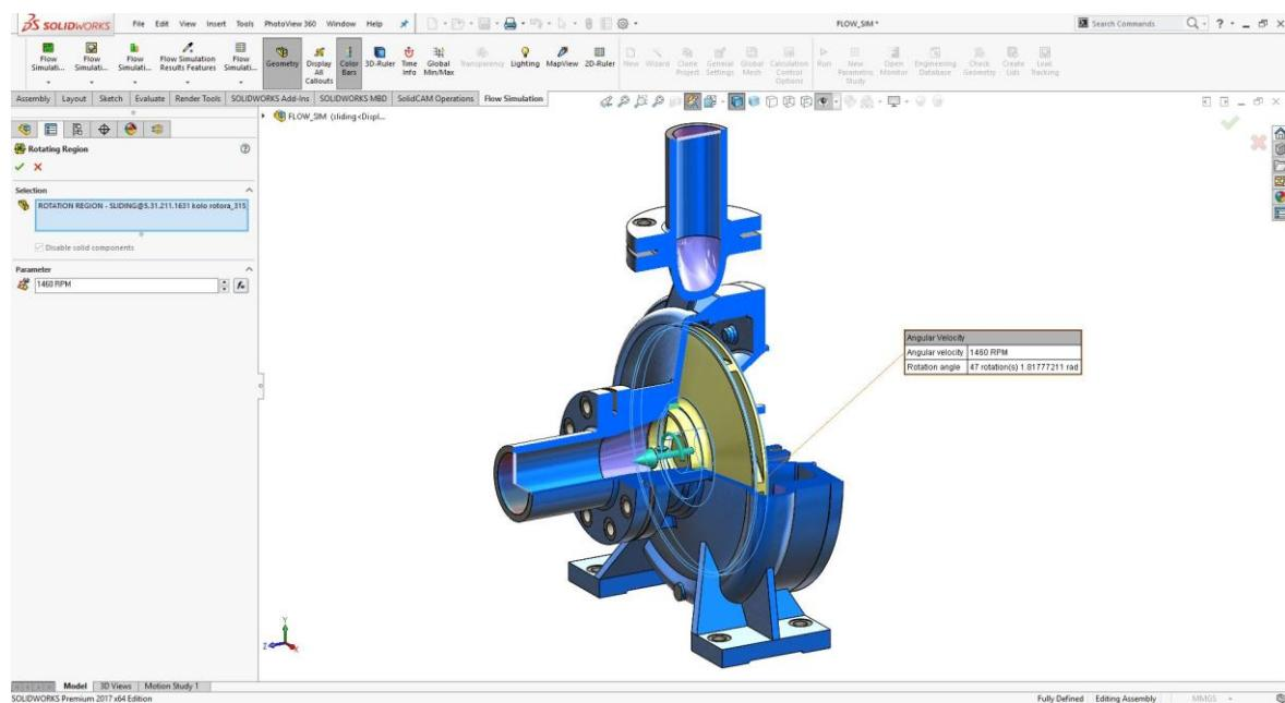
Slika 41. Određivanje regije rotacije i brzine rotiranja
