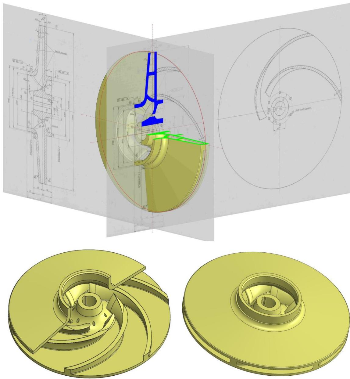
Slika 24. Konstrukcija rotora iz 2D nacrta u 3D model
