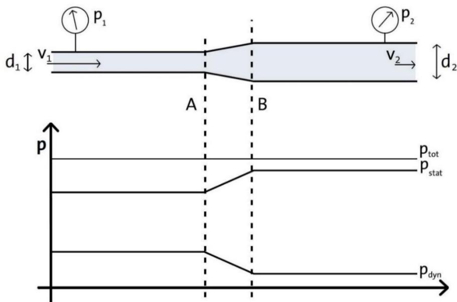
Slika 28. Promjena dinamičkog tlaka u statički preko difuzora
