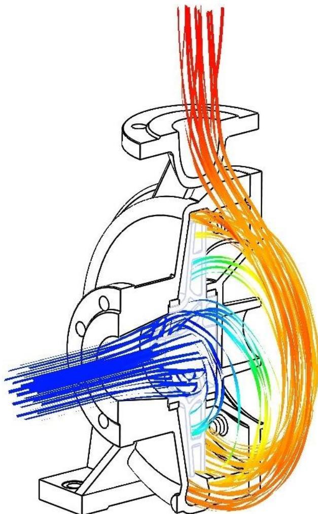
Slika 62. Ilustracija distribucije brzine fluida u centrifugalnoj pumpi
