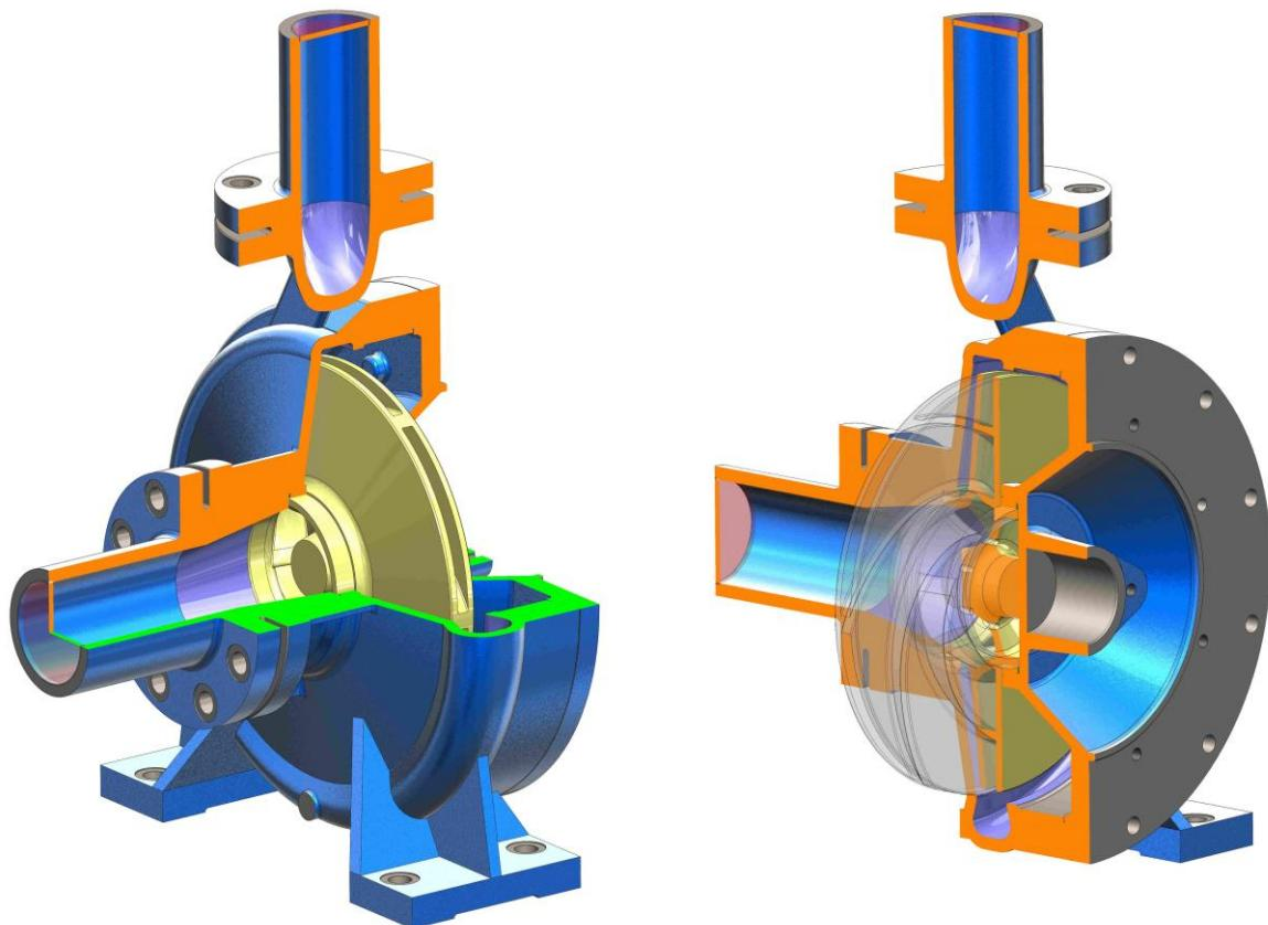
Slika 26. Presjeci dijelova pumpe uključenih u CFD analizu
