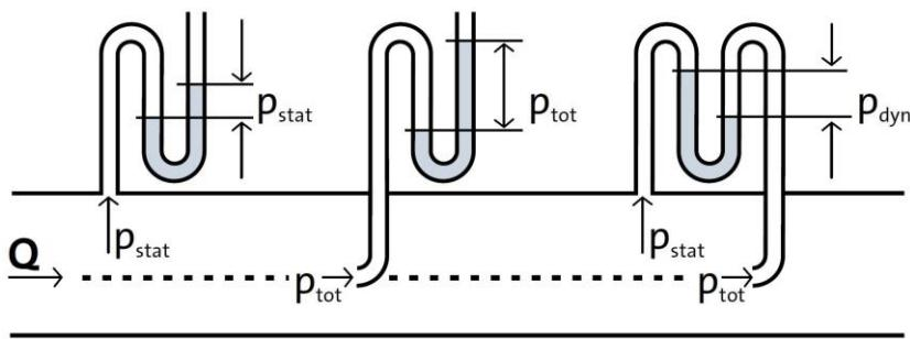
Slika 27. Principi mjerjenja tlaka
