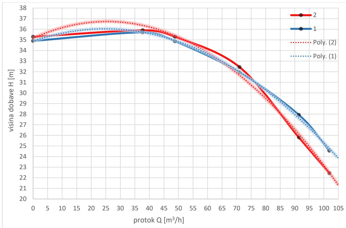
Slika 55. Q – H karakteristike stvarnog i virtualnog mjerena
