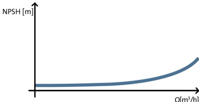
Slika 6. NPSH karakteristika pumpe
