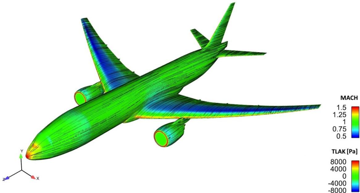
Slika 21. Distribucija tlaka i brzine po površini zrakoplova
