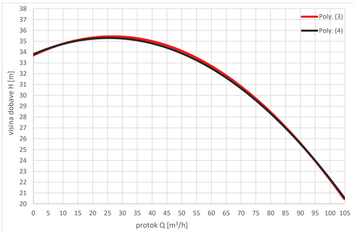
Slika 58. Rezultat CFD analize i nominalnih vrijednosti pumpe
