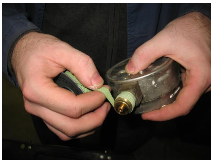
Slika 25. - Namatanje teflonske trake na navoj manometra
