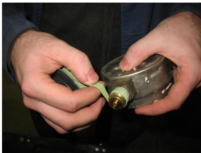
Slika 25. - Namatanje teflonske trake na navoj manometra
