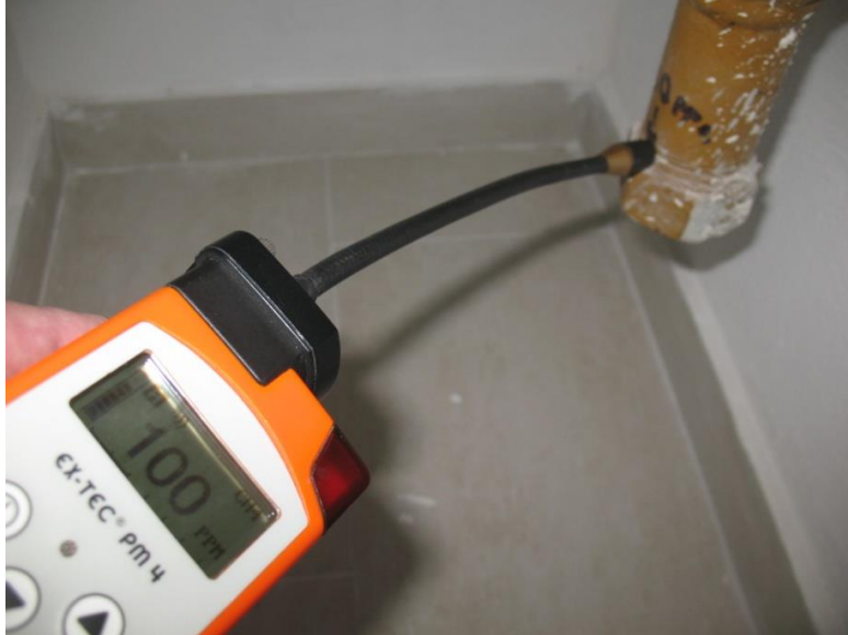
Slika 29. - Indikatorom plina pronađeno propuštanje
