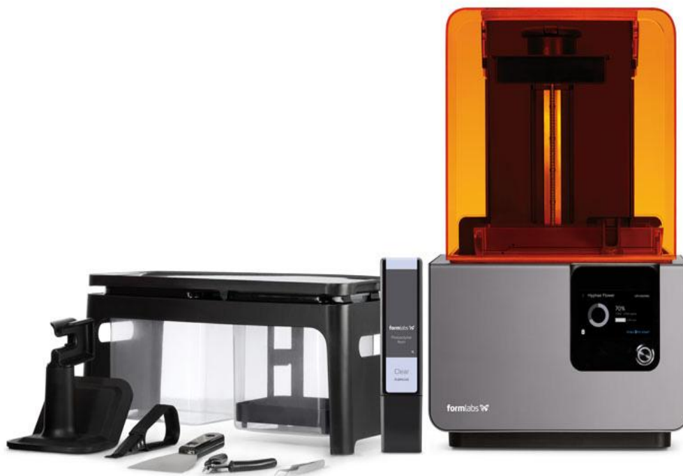
Slika 13. Formlabs Form 2 SLA 3D pisač. [18]
