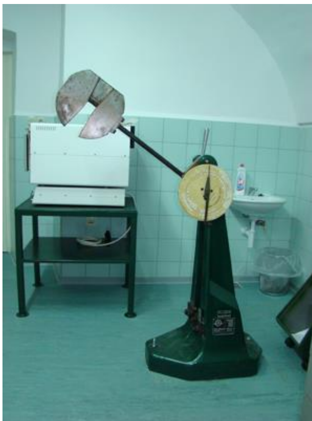
Slika 33. Charpy-evo klatno u laboratoriju Veleučilišta u Karlovcu. [30]
