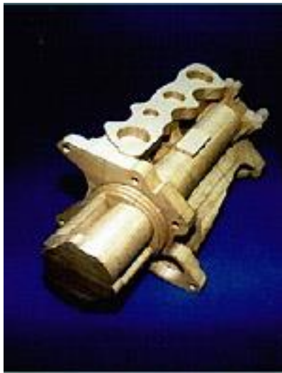
Slika 12. Model bloka motora nastao LOM tehnologijom. [12]
