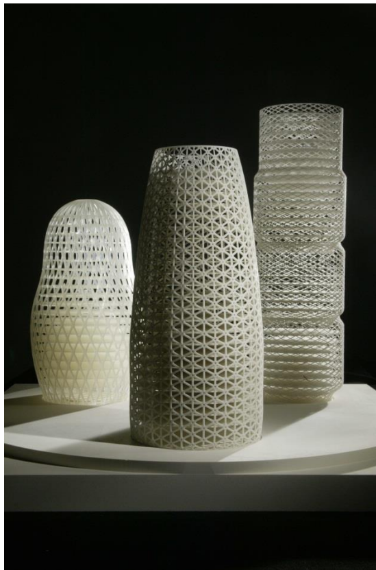
Slika 18. Primjeri modela izrađenih SLS tehnologijom. [18]
