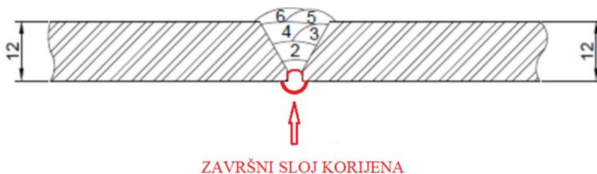
Slika 57. Shematski prikaz završnog zavora nakon brušenja
