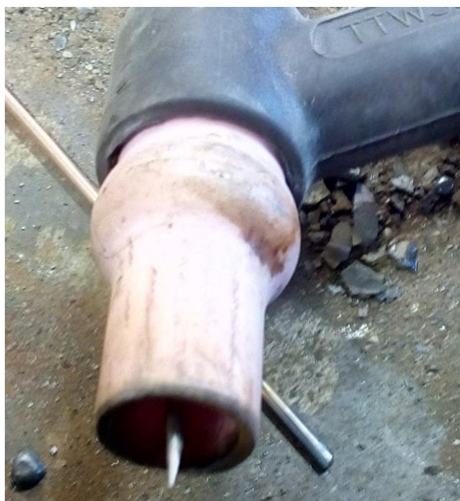
Slika 36. Oblik vrha elektrode
