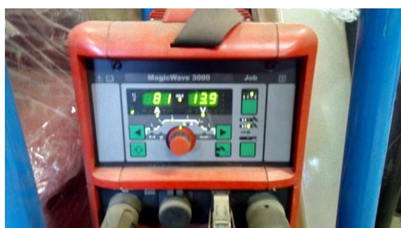
Slika 37. Aparat za zavarivanje s trenutnom jačinom struje i naponom
