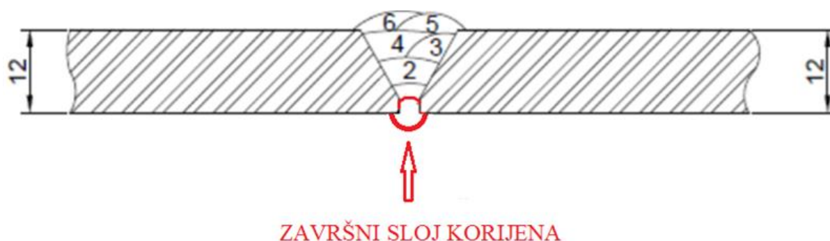
Slika 57. Shematski prikaz završnog zavora nakon brušenja
