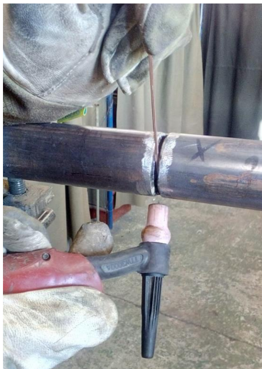
Slika 38. Namještanje elektrode i dodatnog materijala
