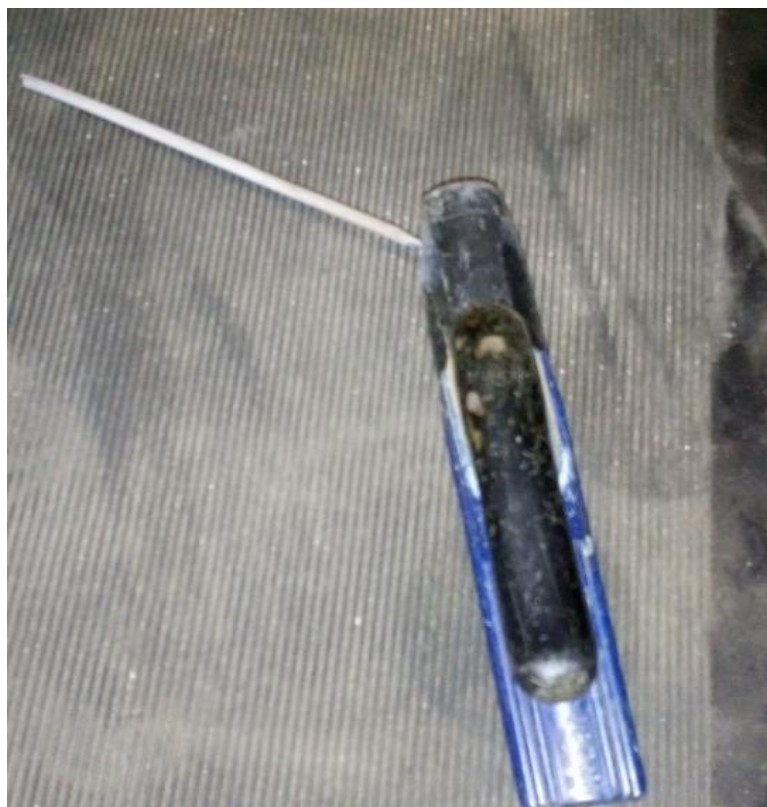
Slika 48. Elektroda u držaču elektode
