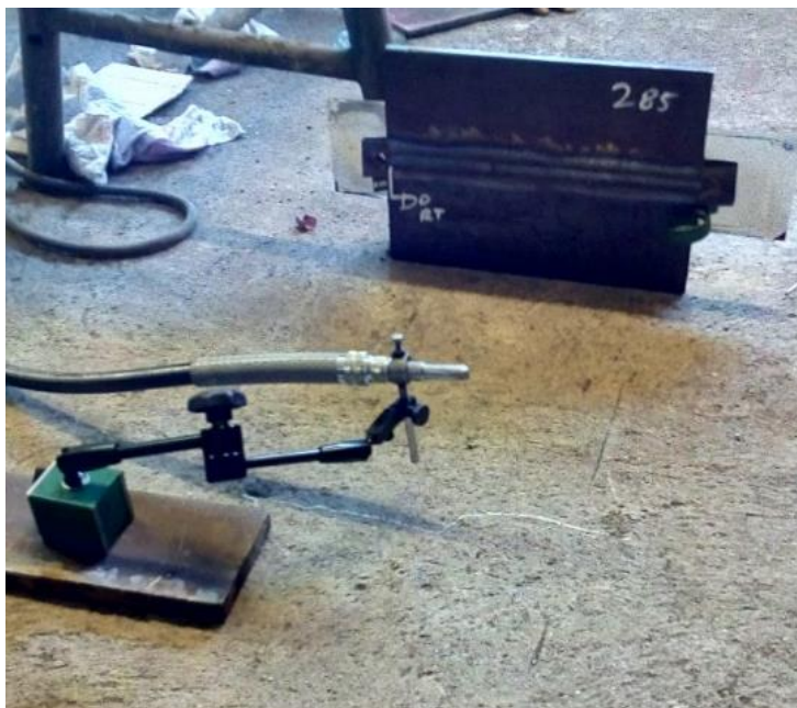
Slika 58. Priprema uzorka za ispitivanje radiografijom
