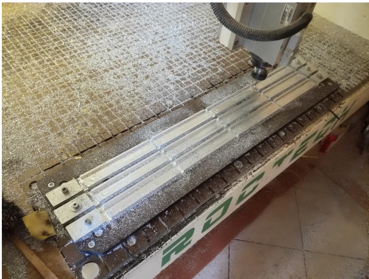
Slika 140. Glodanje aluminijskih pločica
