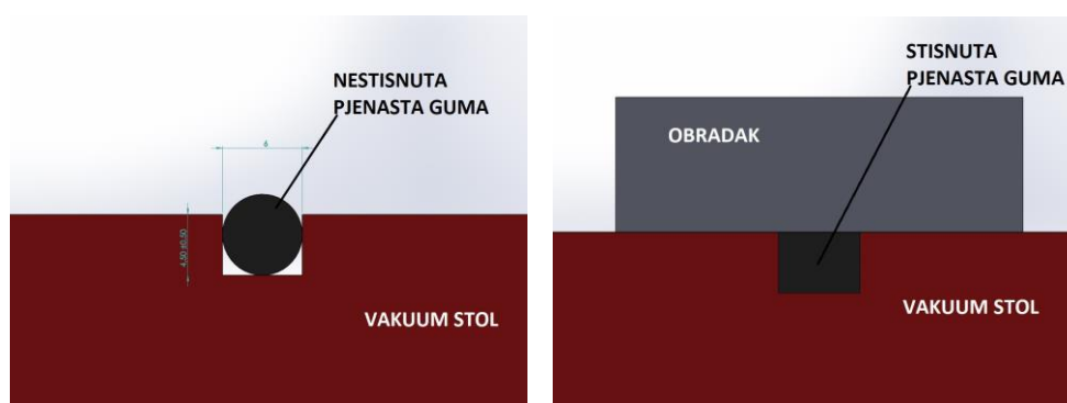
Slika 39. Pjenasta guma bez vakuuma (lijevo) i sa vakuumom (desno)
