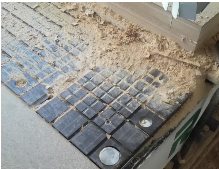
Slika 141. Oštećenje vakuum stola
