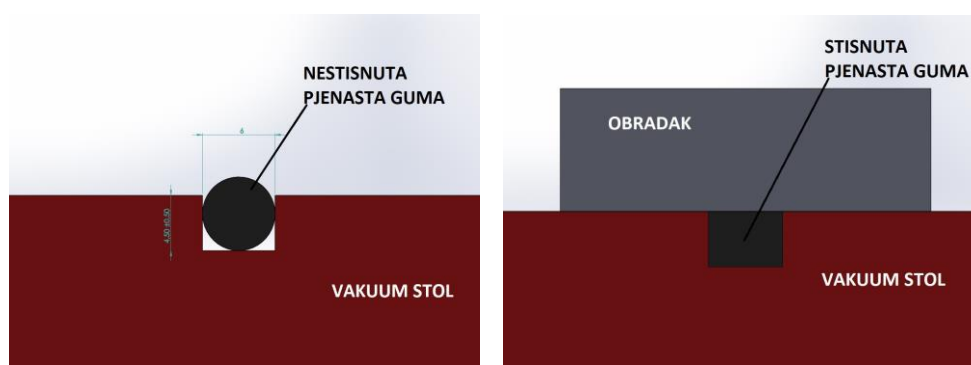
Slika 39. Pjenasta guma bez vakuuma (lijevo) i sa vakuumom (desno)
