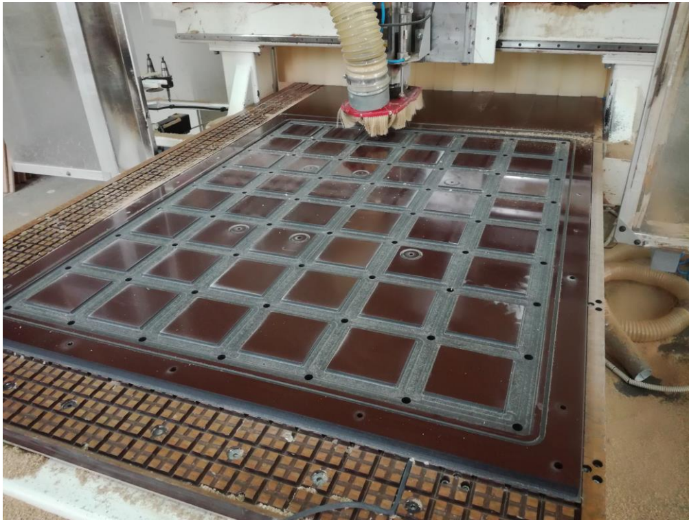
Slika 60. Bušenje rupa i vanjsko obrezivanje
