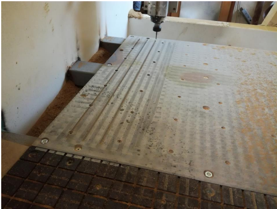
Slika 103. Urezivanje kanala u drugu polovicu vakuum stola
