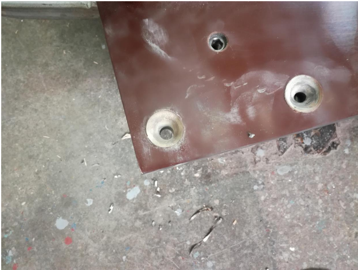
Slika 78. Izbušene rupe u HV limu kroz bakelit
