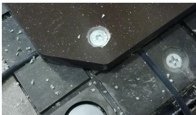
Slika 132. Skošena stezna rupa sa vijkom M8
