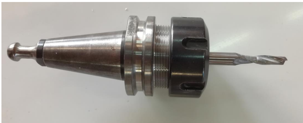
Slika 49. Spiralno dvoperno glodalo promjera 6mm
