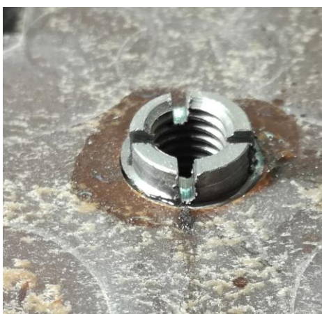
Slika 71. Zarezana i zalijepljena trio matica sa strane komore
