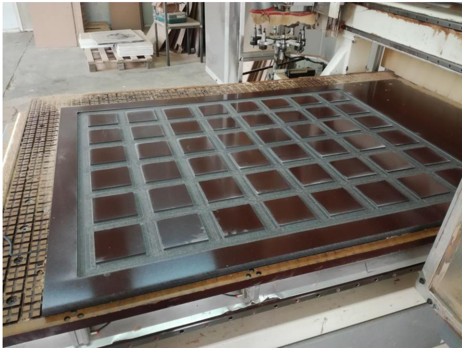
Slika 58. Završetak glodanja komore
