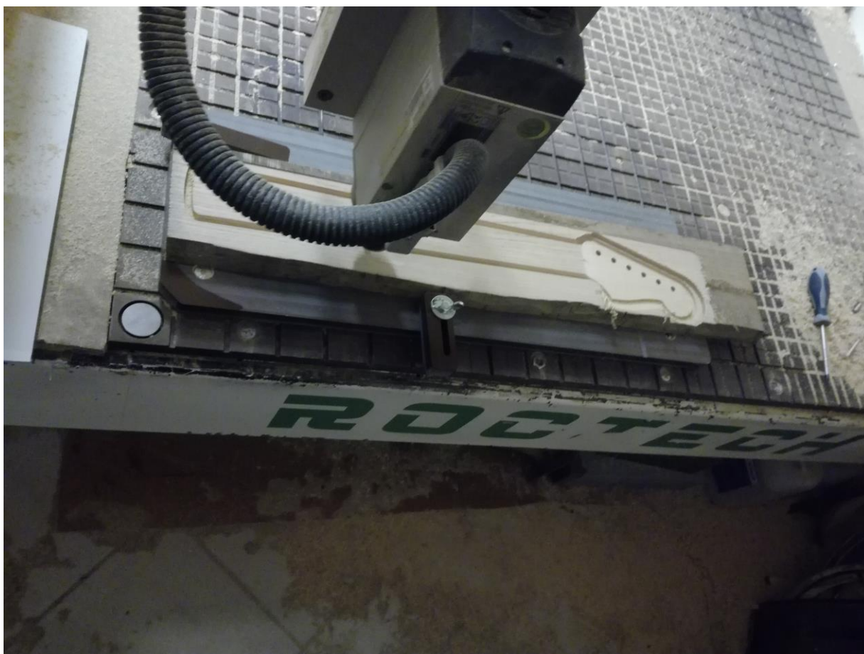
Slika 137. Glodanje prve strane vrata gitare
