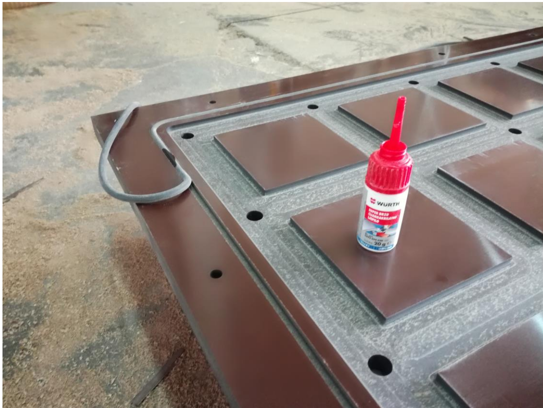
Slika 61. Lijepljenje gumene brtve u komoru vakuum stola
