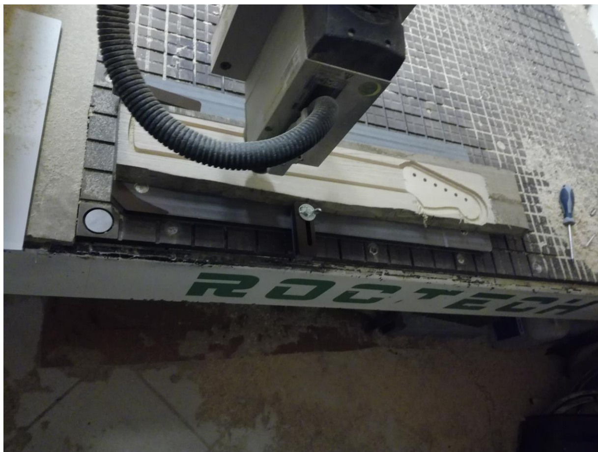
Slika 137. Glodanje prve strane vrata gitare
