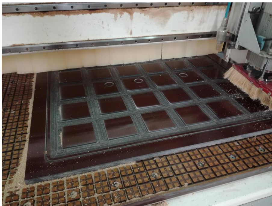
Slika 59. Glodanje kanala za brtvu
