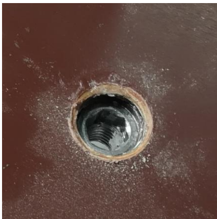
Slika 70. Trio matica u svojoj konačnoj poziciji
