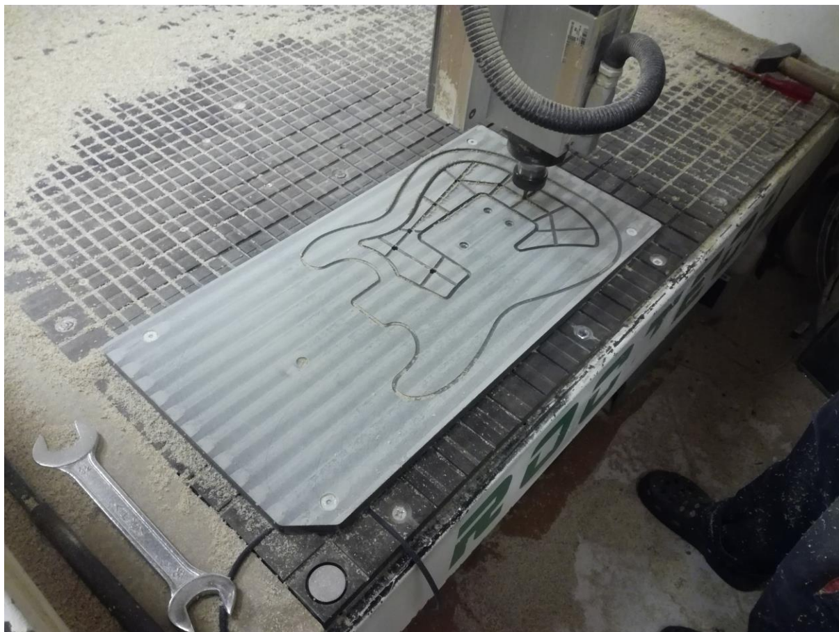
Slika 133. Glodanje šablone za tijelo gitare
