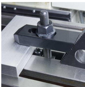
Slika 23. Obradak stegnut t-slot načinom korištenjem stupnjevite prizme
