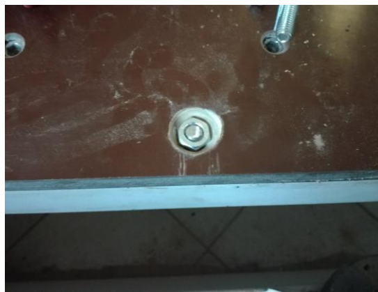
Slika 90. Improvizirani vijak M10x130 ugrađen u vakuum stol
