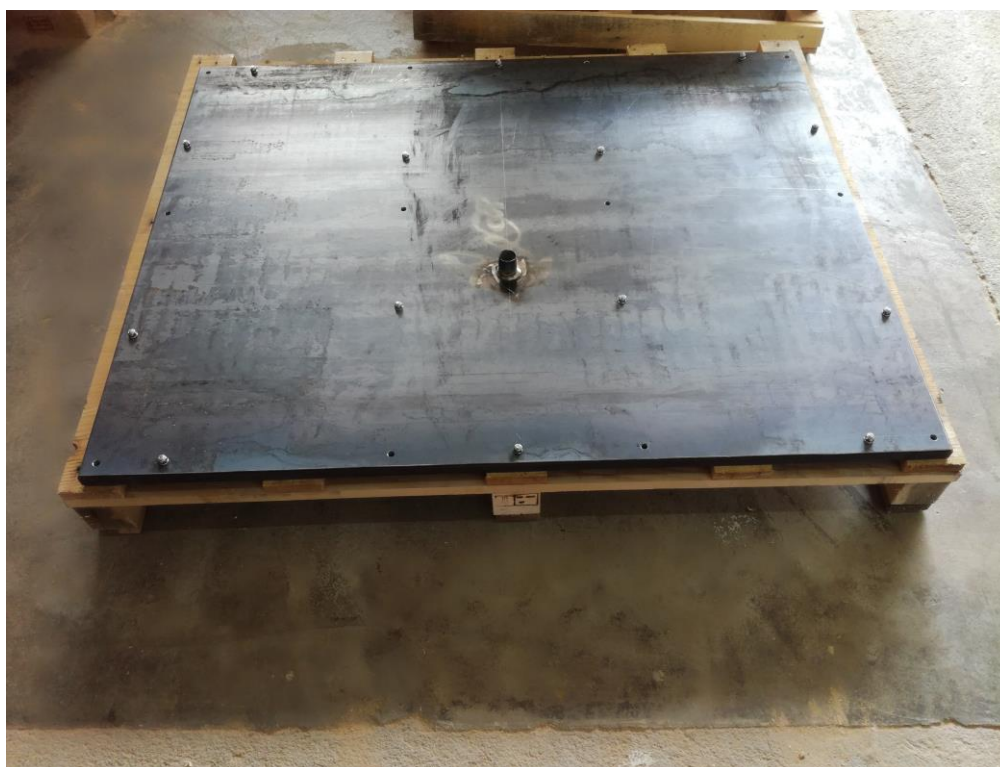
Slika 86. Dovršena polovica vakuum stola (pogled odozdo)
