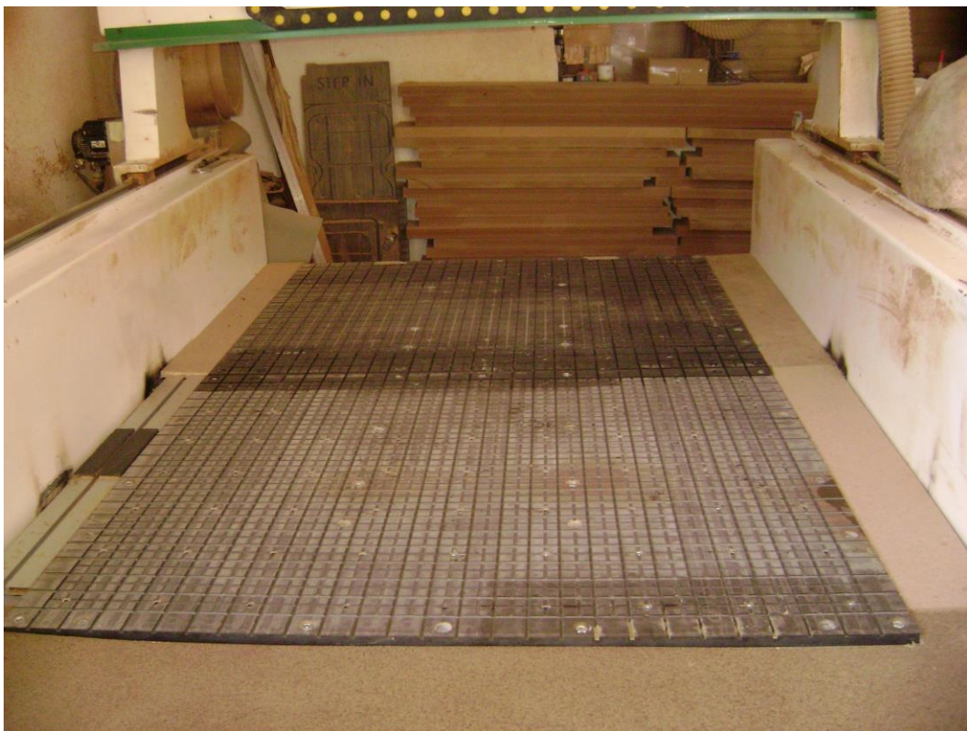
Slika 104. Završen vakuum stol spreman za korištenje
