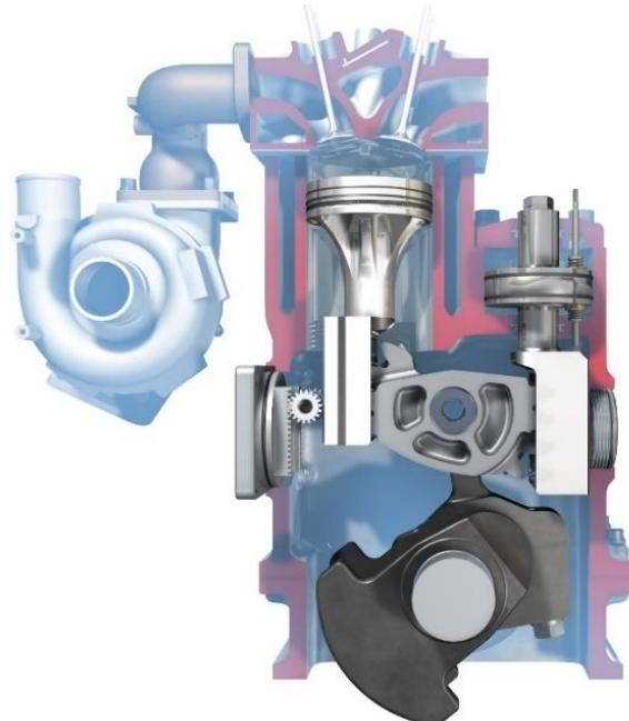
Slika 43. Pomak putem hidrauličnog sklopa [19]
