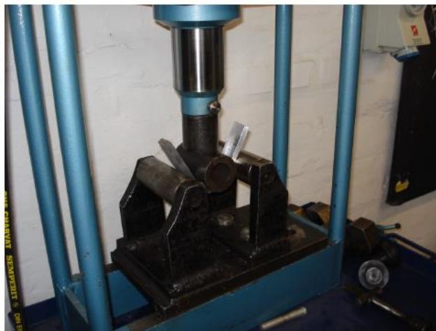
Slika 54. Predodžba epruvete na napravi za savijanje [26]
