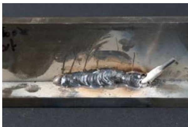
Slika 20. Kratka duljina električnog luka [2]
