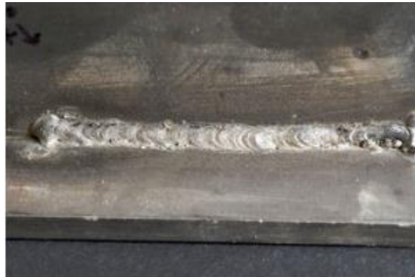
Slika 25. Prevelika brzina zavarivanja [2]
