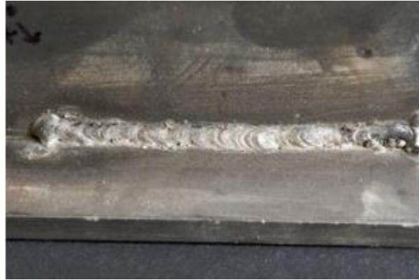
Slika 25. Prevelika brzina zavarivanja [2]
