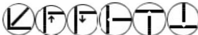
Slika 34. Položaji zavarivanja celuloznom elektrodom [20]
