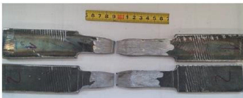
Slika 47. Predodžba epruvete nakon statičkog vlačnog pokusa [5]
