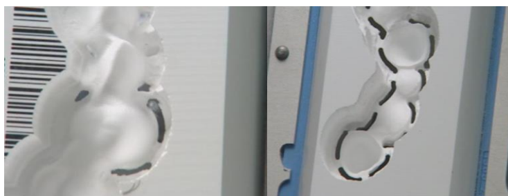
Slika 27. Grubo glodanje i fino glodanje
