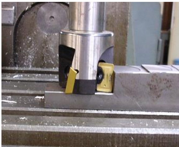
Slika 14. Čeono ravno glodanje (simetrično, asimetrično) [18]
