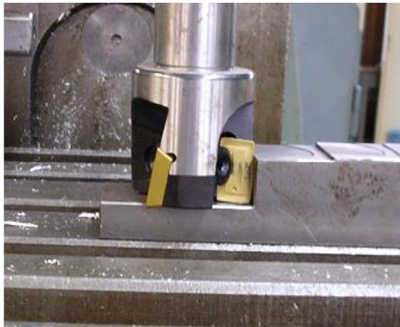
Slika 14. Čeono ravno glodanje (simetrično, asimetrično) [18]
