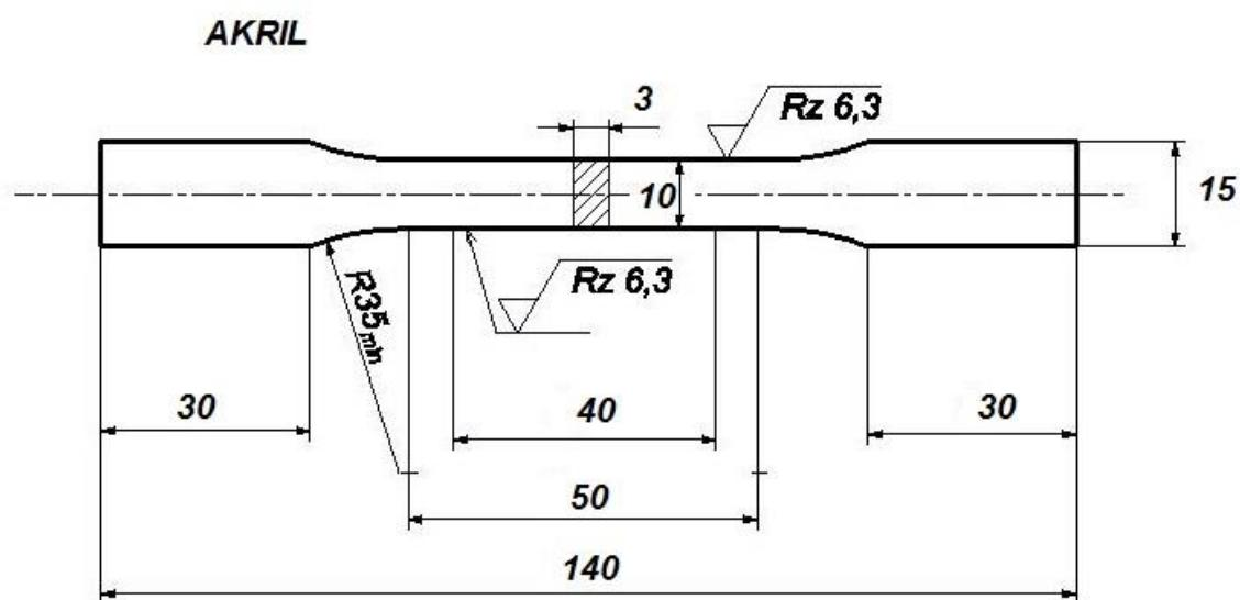
Slika 62. Dimenzije epruveta sanitarnog poli(metil-metakrilata)
