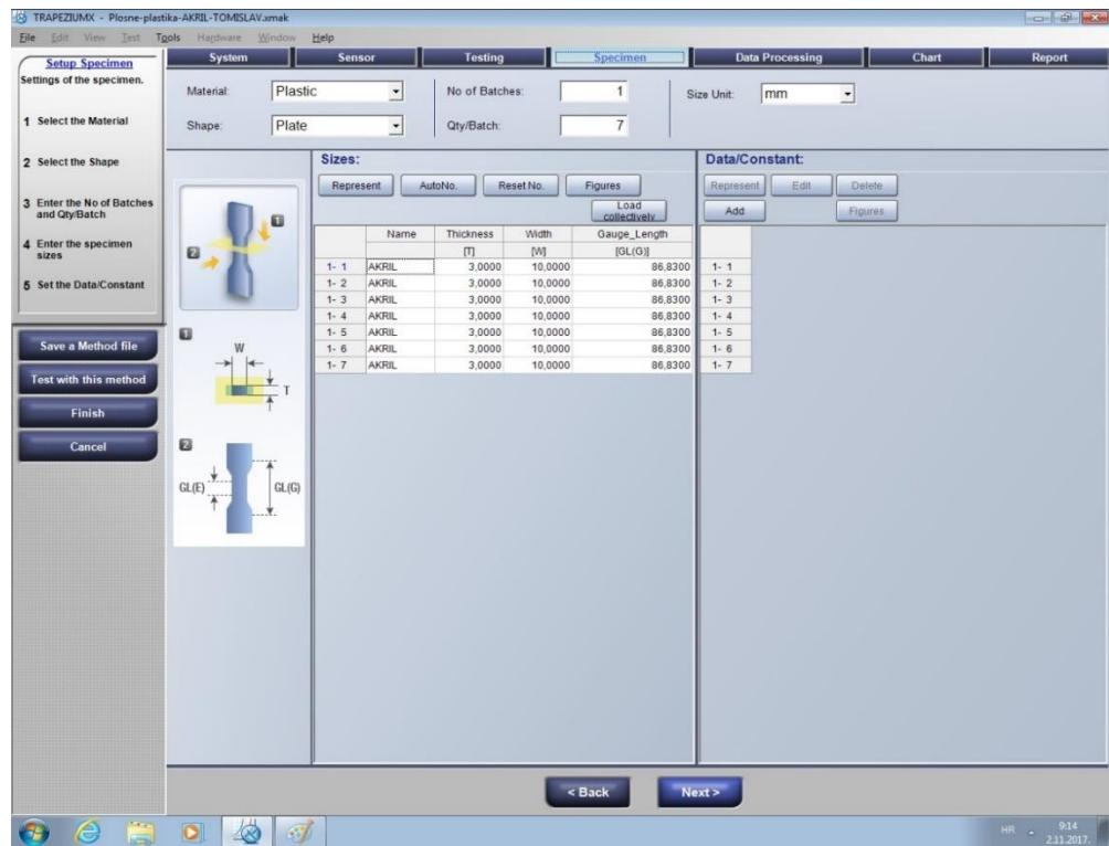
Slika 55. Odabir materijala i dimenzije epruvete, sanitarni poli(metil-metakrilat)
