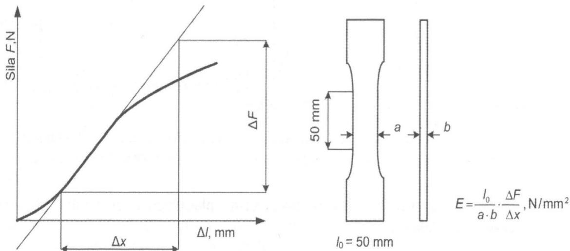
Slika 15. Postupak određivanja modula elastičnosti polimernih materijala [2]
