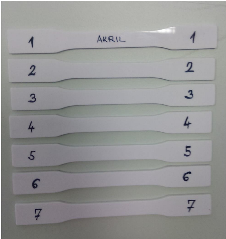
Slika 61. Epruvete sanitarnog poli(metil-metakrilata), na kojima se vršilo ispitivanje statičkog vlačnog pokusa
