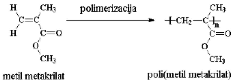
Slika 26. Polimerizacija metil-metakrilata i nastajanje poli(metil-metakrilata) [9]
