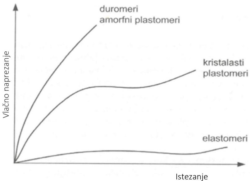
Slika 12. Hooke-ov dijagram "naprezanja-istezanja" osnovnih skupina polimernih materijala [2]
