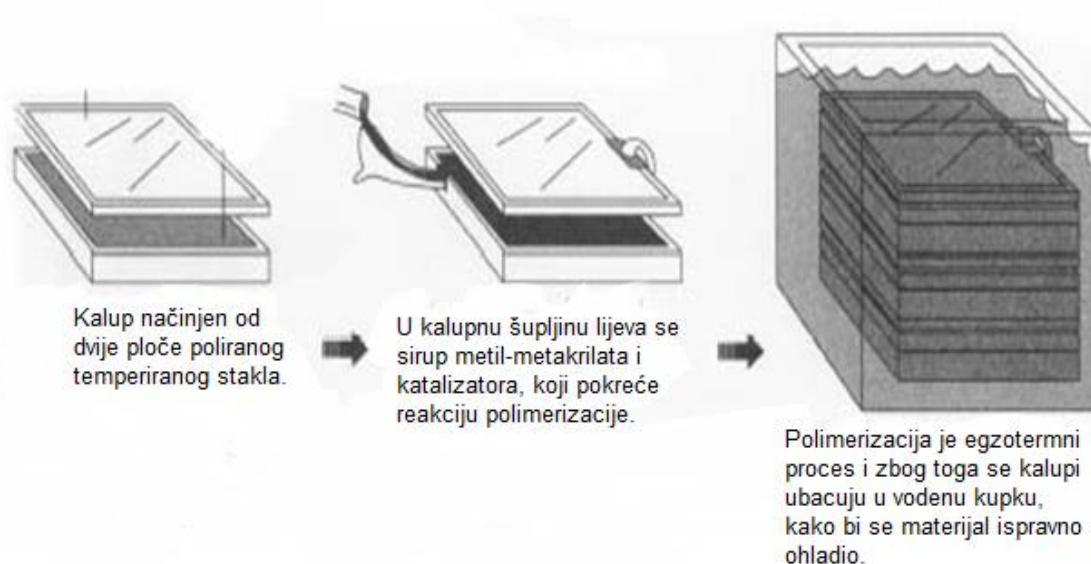
Slika 28. Primjer serijskog lijevanja poli(metil-metakrilata) [9]
