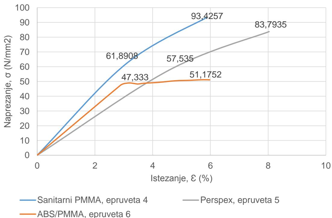
Slika 71. Dijagram statičkog vlačnog pokusa, najvećih izmjerениh vrijednosti ispitanih epruveta
