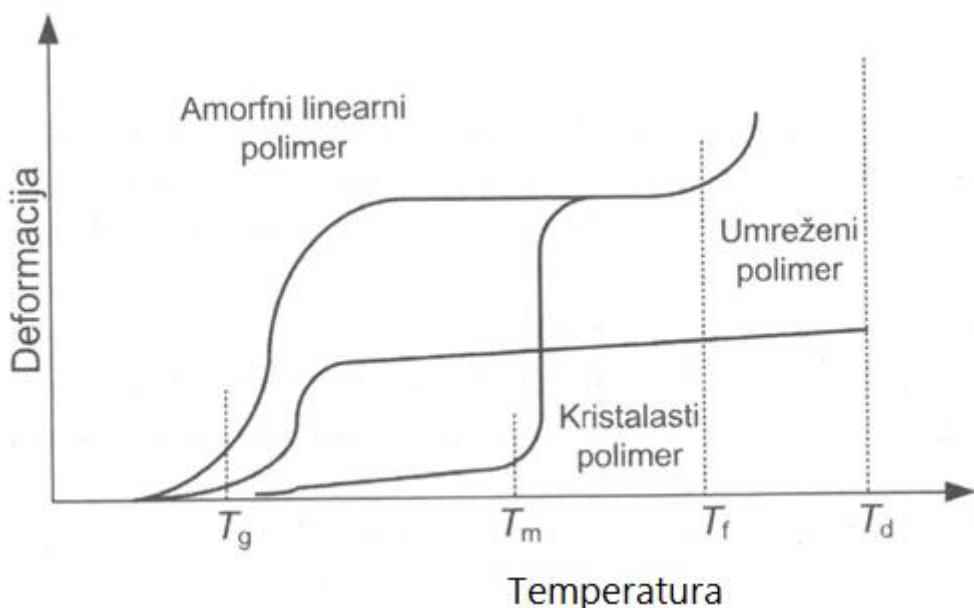
Slika 10. Termomehanička krivulja ( $T_g$ -staklište,  $T_m$ -tecište kristalastih plastomera ,  $T_f$ -tecište amorfnih plastomera,  $T_d$ -temperatura razgradnje) [1]
