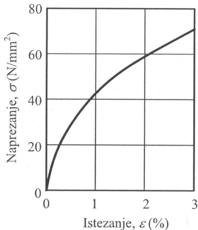
Slika 30. Prikaz ovisnosti naprezanja o istezanju PMMA [6]
