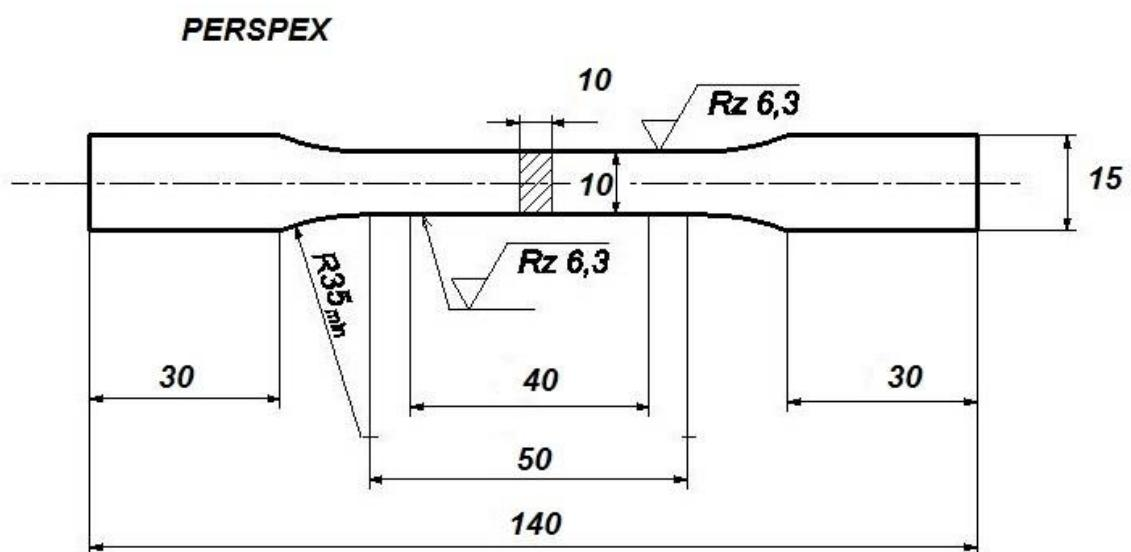
Slika 64. Dimenzije epruveta Perspex poli(metil-metakrilata)
