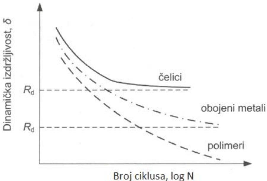
Slika 17. Prikaz ponašanja polimernih materijala kod dinamičkog opterećenja [1]
