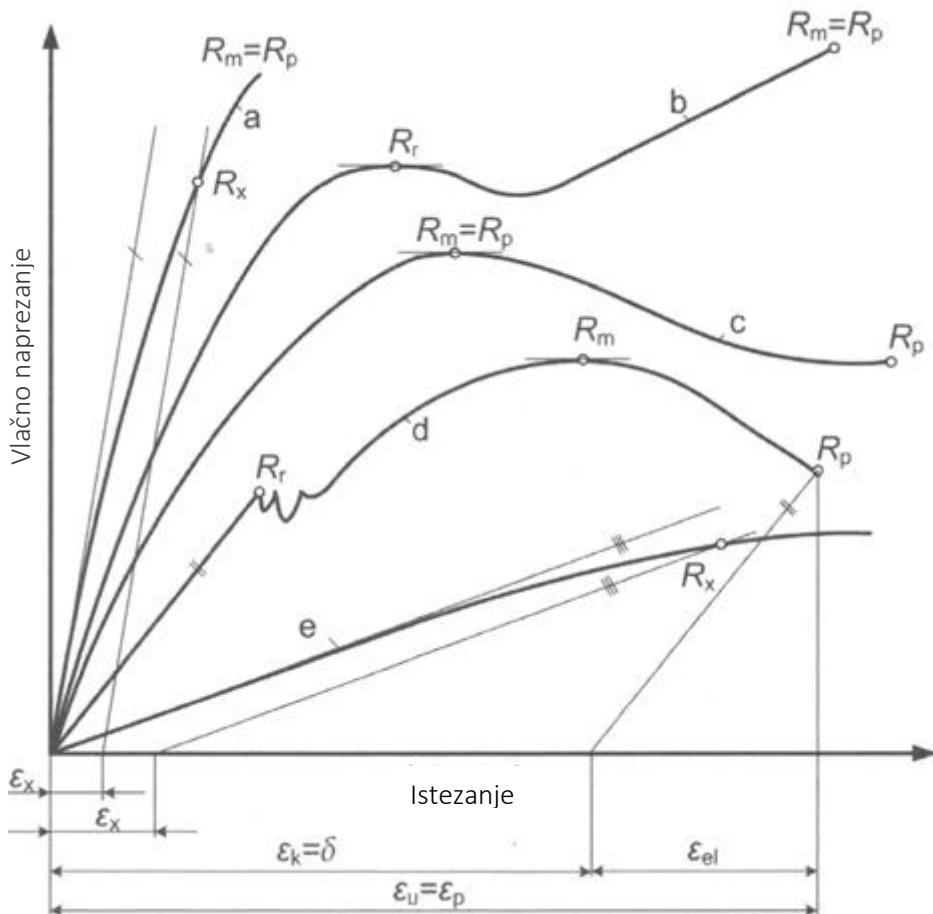
Slika 14. Vrste krivulja pri vlačnom ispitivanju [1]
