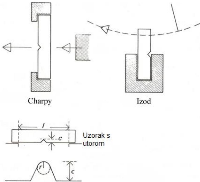
Slika 21. Prikaz ispitivanja udarnog rada loma Charpy i Izod metodom [43]
