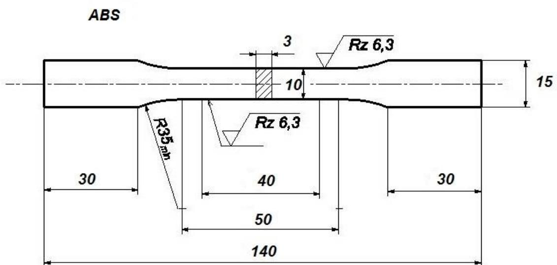
Slika 66. Dimenzije epruveta akrilonitril/butadien/stirena koekstrudiranog slojem poli(metil-metakrilata)
