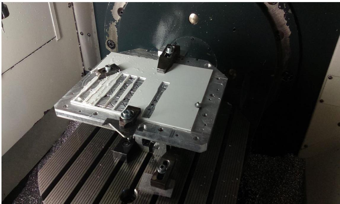
Slika 60. Epruvete izrađene pomoću numeričko upravljanog alatnog stroja
