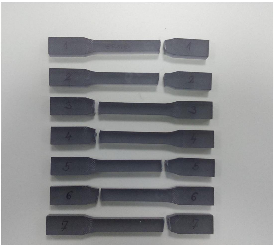
Slika 68. Epruvete Perspex poli(metil-metakrilata), nakon ispitivanja
