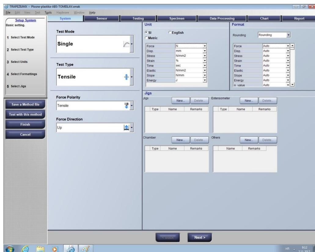
Slika 52. Odabir konstantne vlačne sile i smjera sile
