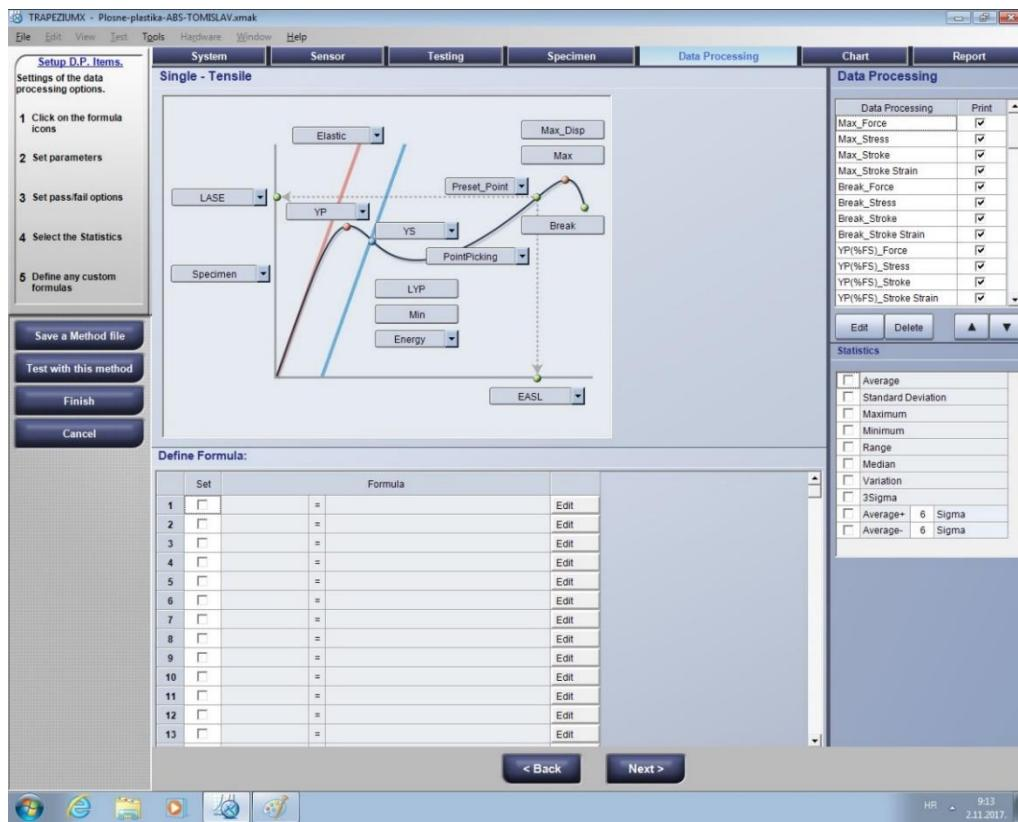
Slika 58. Definiranje parametara koji će se mjeriti
