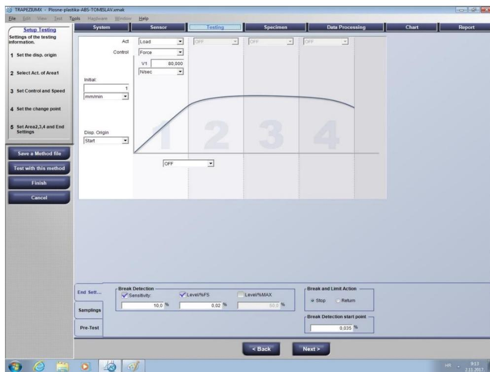
Slika 54. Postavljanje brzine ispitivanja od 80 N/sec
