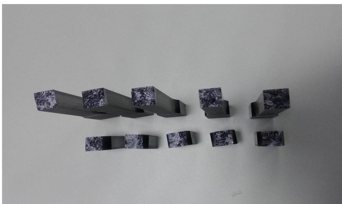
Slika 69. Prikaz presjeka loma epruveta Perspex poli(metil-metakrilata)
