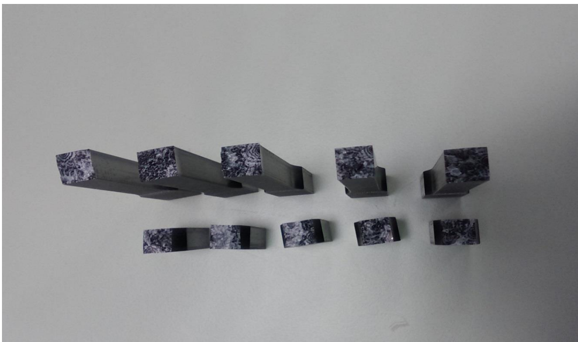
Slika 69. Prikaz presjeka loma epruveta Perspex poli(metil-metakrilata)
