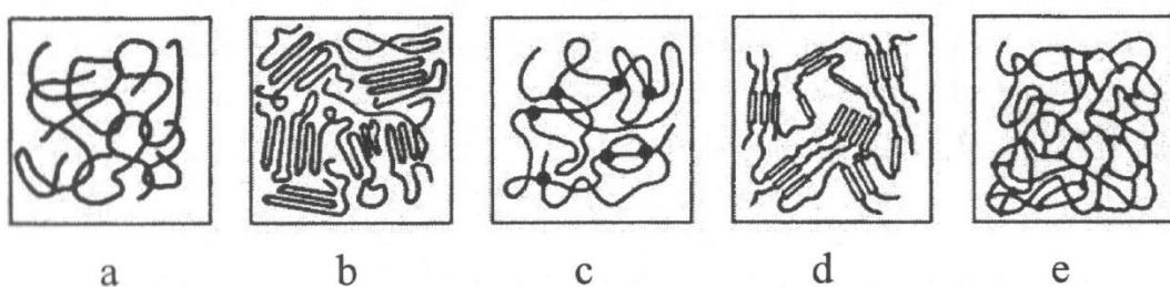
Slika 25. Oblici molekulne strukture osnovnih polimernih skupina [6]
