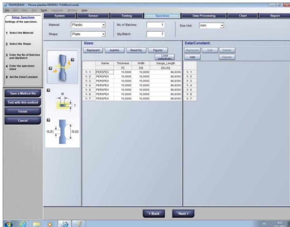
Slika 56. Odabir materijala i dimenzije epruvete, Perspex poli(metil-metakrilat)
