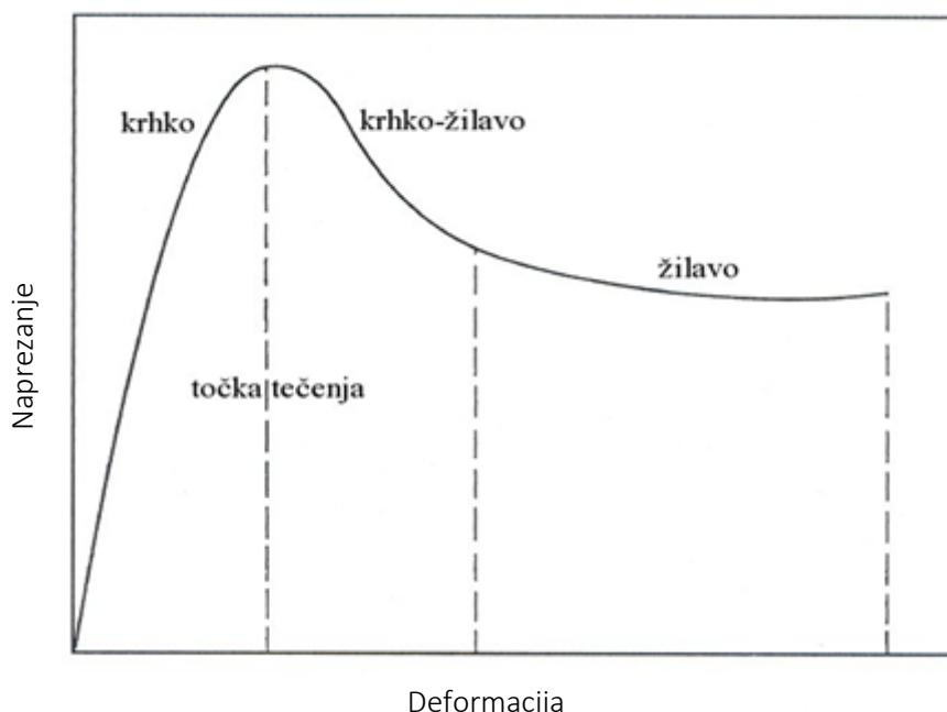
Slika 19. Prikaz krivulje "naprezanje - deformacija", žilavog materijala [43]
