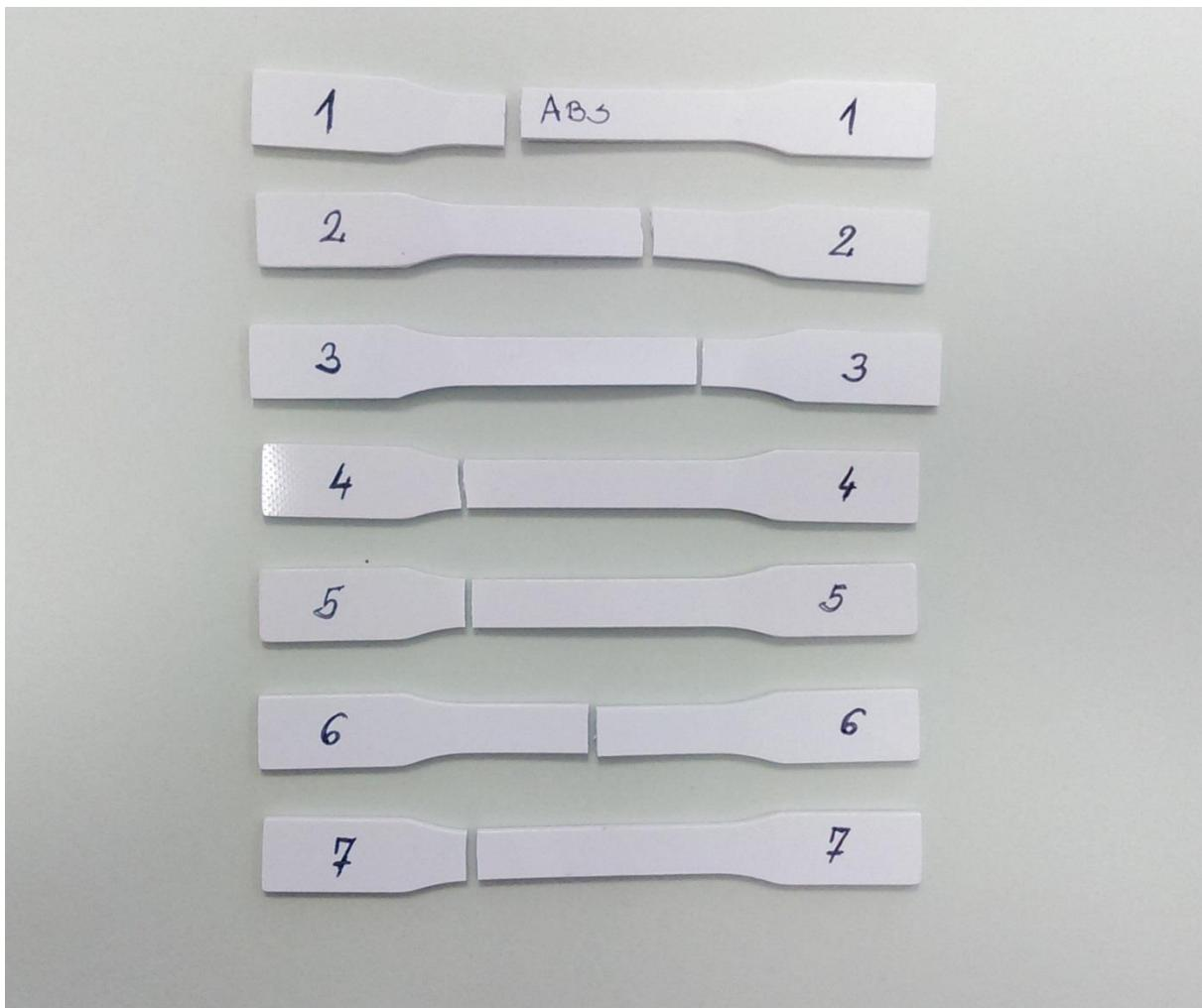
Slika 70. Epruvete akrilonitril/butadien/stirena koekstrudiranog slojem poli(metil-metakrilata), nakon ispitivanja
