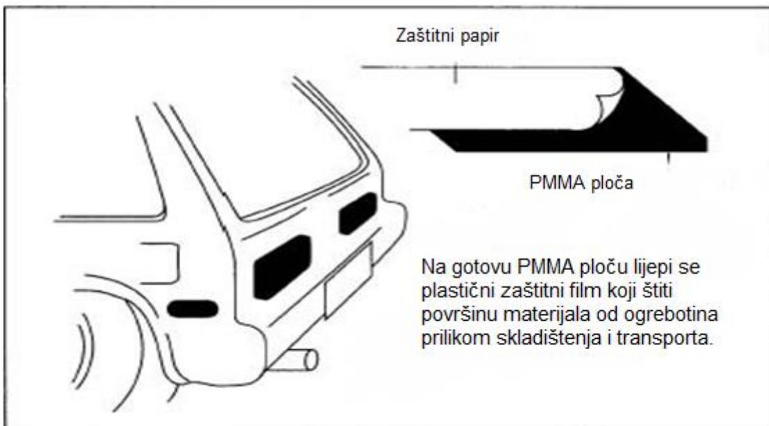
Slika 29. Lijepljenje zaštitne folije na gotovu PMMA ploču [9]
