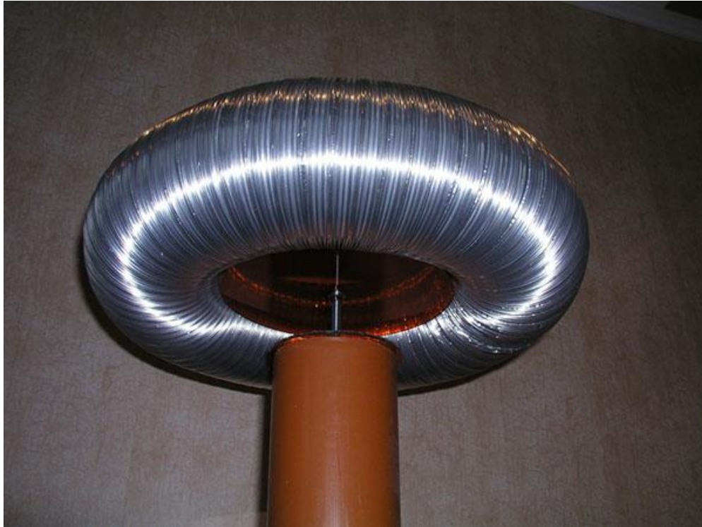
Slika 29. Prsten spojen na sekundar Tesline zavojnice [3]
