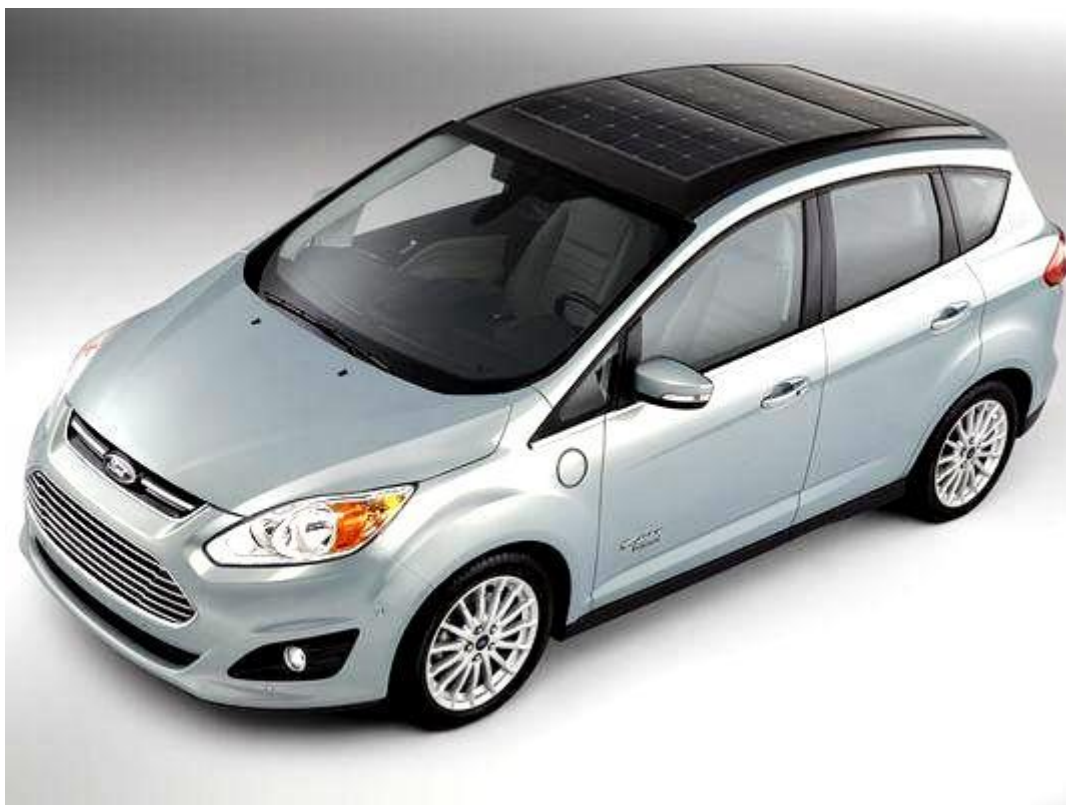
Slika 21. Ford C-Max sa fotonaponskim panelima za punjenje baterije [3]
