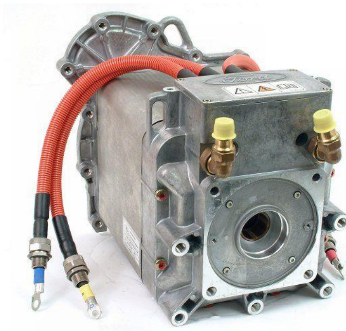
Slika 3. 3-phase AC motor za električni automobil [3]
