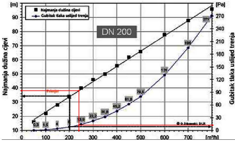
Slika 5. 5. Ovisnost duljine cijevi i pada tlaka zemnog izmjenjivača promjera 0.2 m
