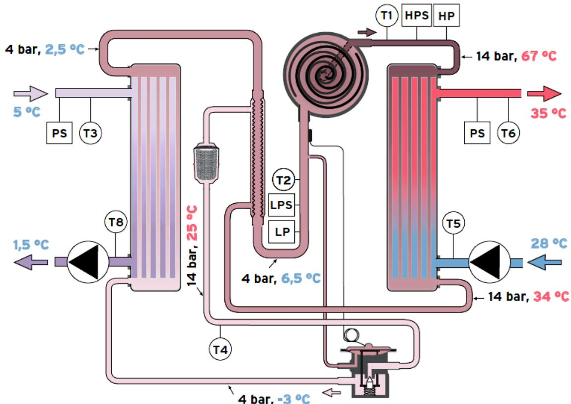
Slika 2. 16. Princip rada kompresijske dizalice topline
