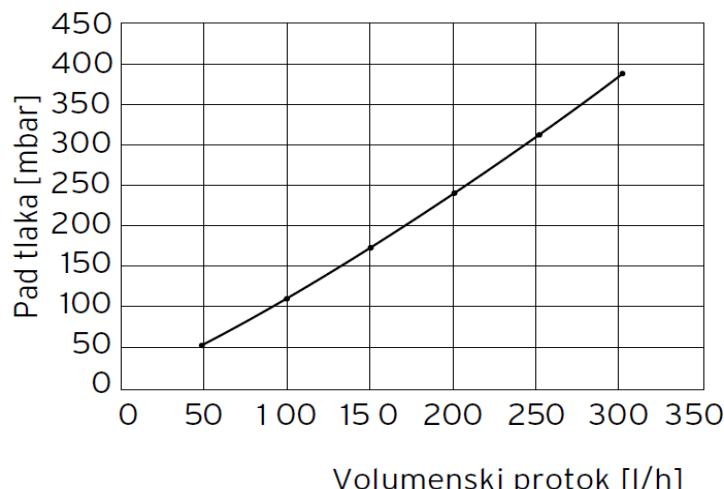
Slika 5. 2. Ovisnost pada tlaka o protoku kolektora
