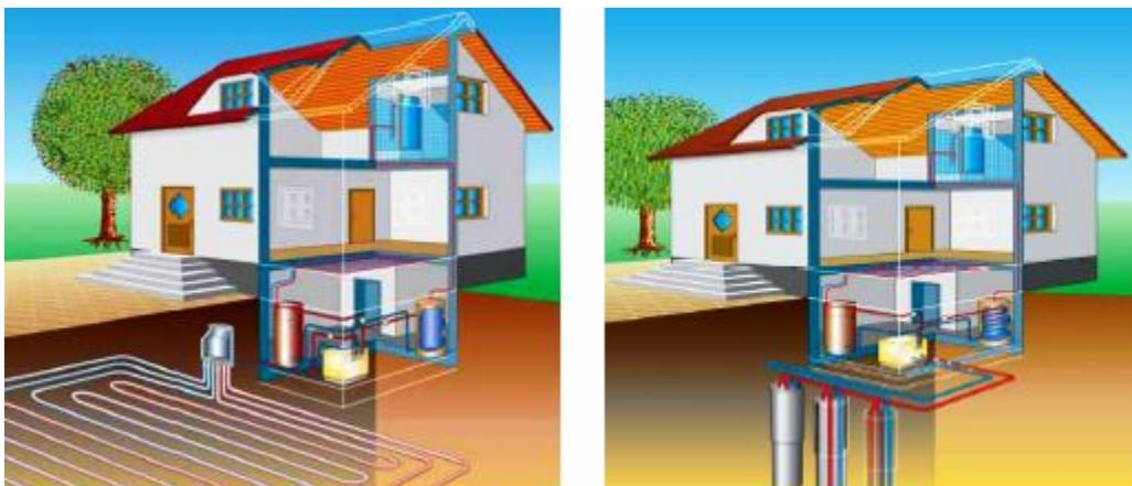
Slika 2. 21. Iskorištenje zemljine topline (vertikalne sonde i horizontalni kolektori)
