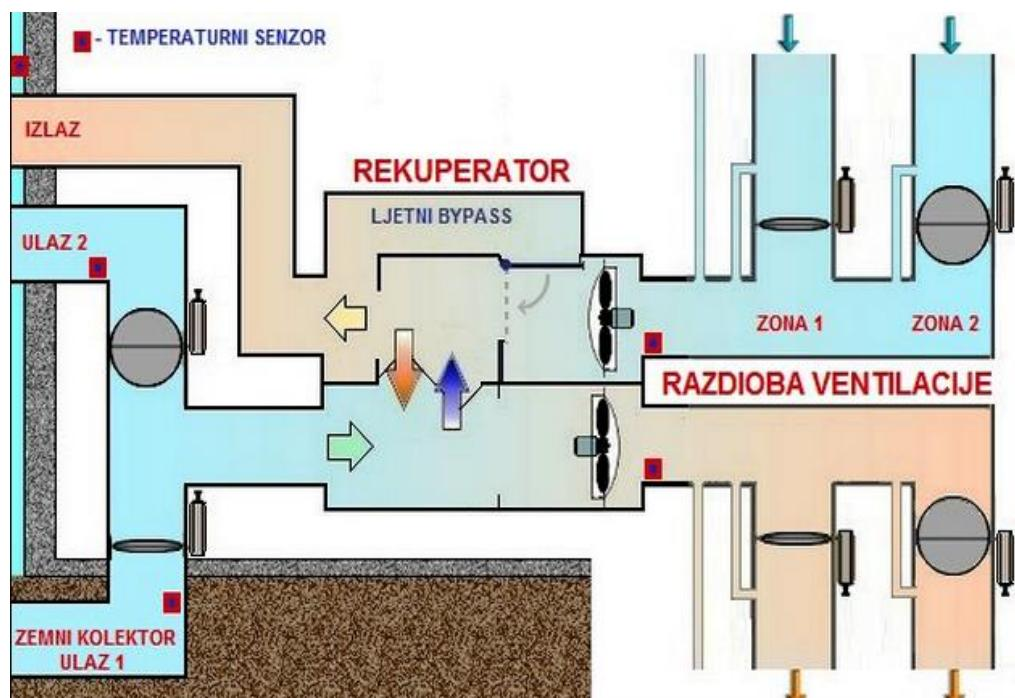
Slika 2. 26. Princip rada rekuperatora sa zemnim izmjenjivačem topline
