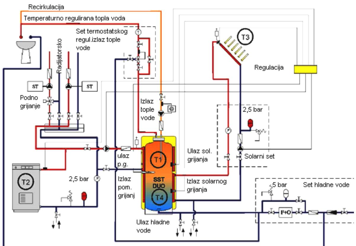
Slika 2. 8. Montaža i spajanje automatičke solarnog sustava pripreme PTV-e
