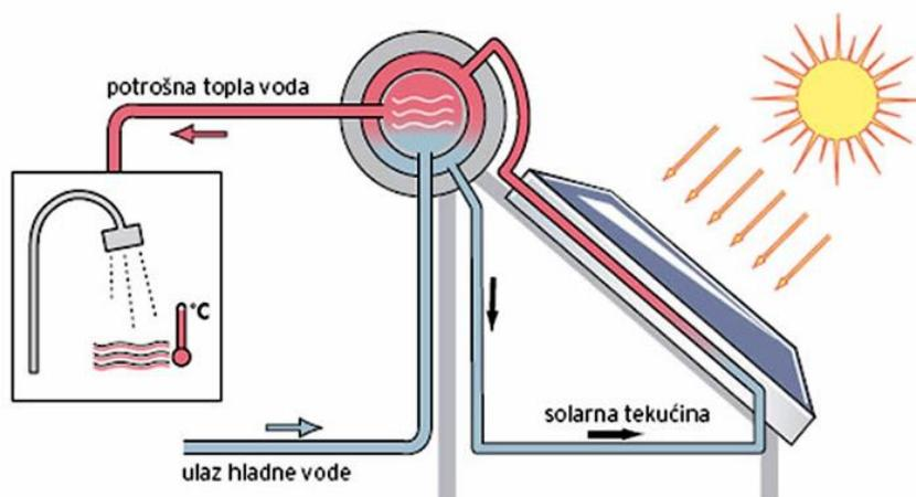
Slika 2. 9. Princip rada solarnog sustava s prirodnom cirkulacijom
