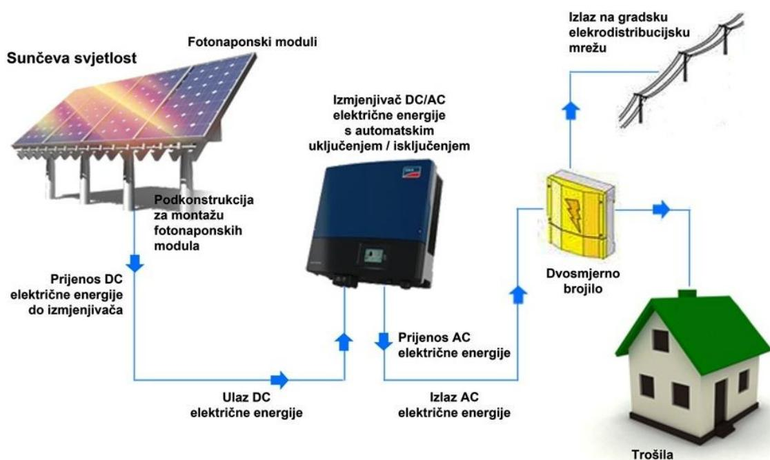
Slika 2. 14. Princip rada fotonaponskog autonomnog sustava
