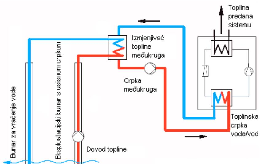
Slika 2. 22. Princip rada dizalice topline,voda/voda, primjenom eksplotacijskog bunara
