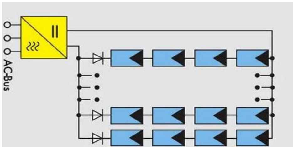
Slika 4. 4. Shema spajanja PV generatora i inverteera (centralni pretvarač)
