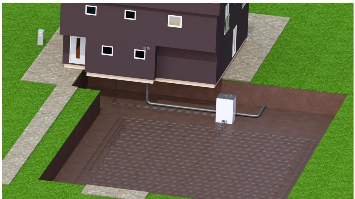
Prikaz zračno-zemnog izmjenjivača rekuperatora i zemnog vodoravnog kolektorskog polja toplinske pumpe ukopanih 1.5 m pod zemljom
