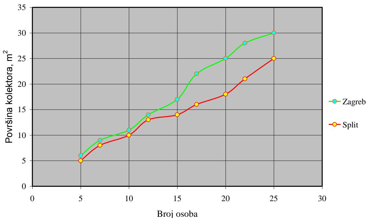
Slika 2. 12. Optimalna površina kolektora ( nagib  $45^\circ$  ) u ovisnosti broja osoba
