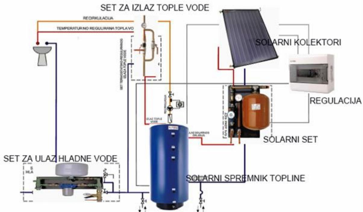
Slika 2. 4. Solarni sustav za pripremu PTV-a
