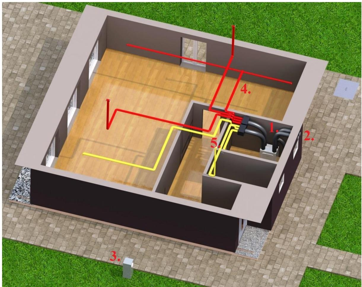
Ventilacijsko-rekuperacijski sustav sa razvodom ulaznih (crvene) i izlaznih (žute) cijevi:
