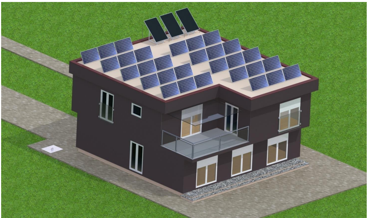
Slika 4. 2. 3D prikaz FN modula i solarnih toplinskih kolektora na krovu objekta
