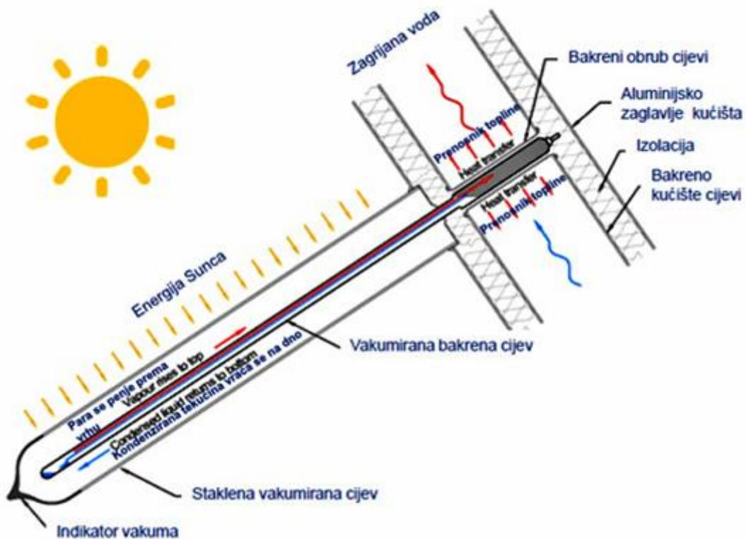
Slika 2. 6. Princip rada „heat pipe“ kolektora
