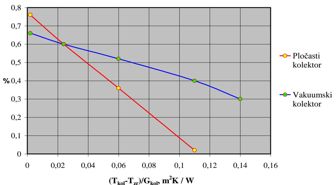
Slika 2. 11. Krivulja efikasnosti pločastog i vakuumskog kolektora
