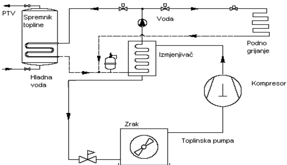
Slika 2. 23. Princip rada dizalice topline zrak/voda
