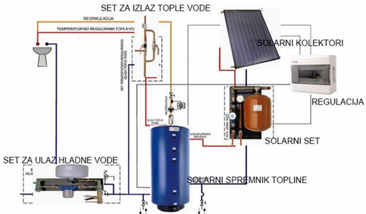
Slika 2. 4. Solarni sustav za pripremu PTV-a
