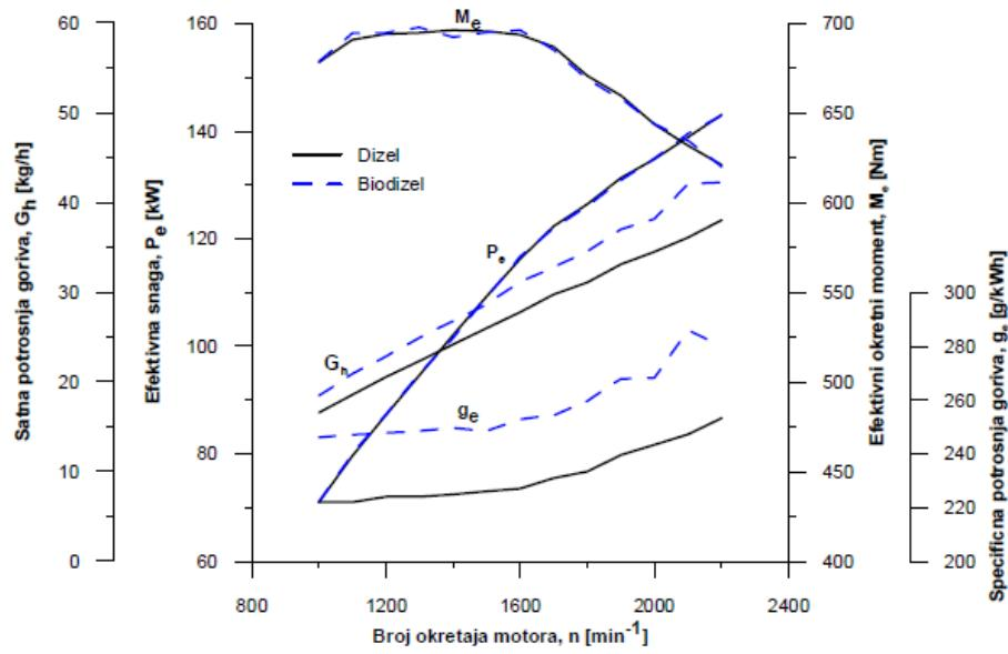
Slika 15. Performance motora s kutom ubrizgavanja od  $21^\circ$  KV prije GMT
