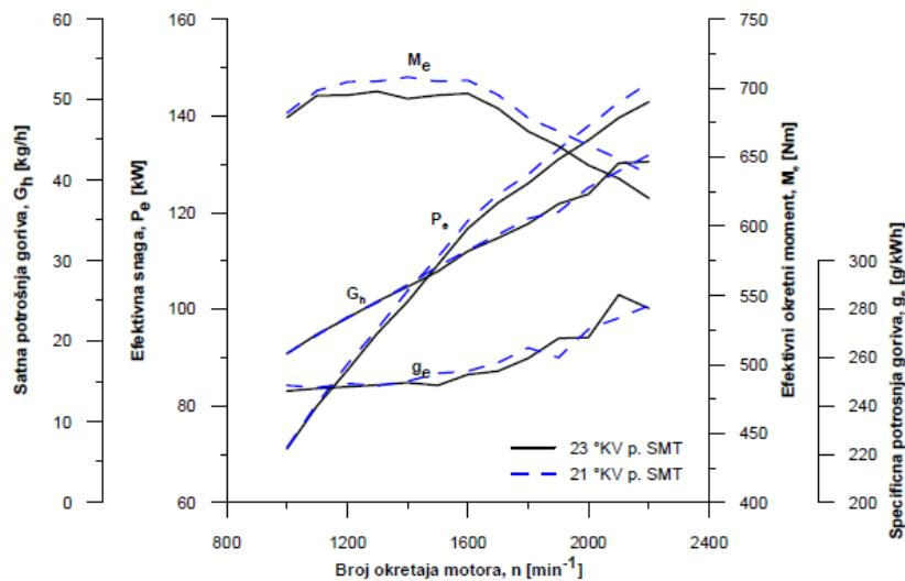
Ako se napravi usporedba prethodno razmatranih veličina, ovisno o kutovima ubrizgavanja goriva, ali za jedno te isto gorivo, vrlo lako dolazimo do zaključka da se smanjenjem kuta ubrizgavanja, sa  $23^\circ$  KV na  $21^\circ$  KV, neznatno mijenja efektivna snaga  $P_e$ , odnosno efektivni okretni moment  $M_e$  i za slučaj korištenja biodizelskog i dizelskog goriva.
