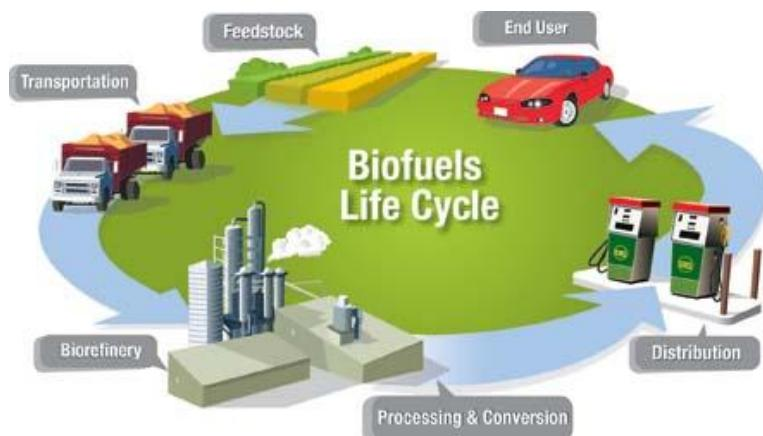
Klimatski utjecaj biogoriva uvelike ovisi o energetskoj bilanci goriva – a to je odnos količine energije oslobođene izgaranjem biogoriva i količine fosilne energije potrebne tokom procesa proizvodnje biogoriva. Ovo pak zauzvrat ovisi o energijskoj intenzivnosti (odnos utroška energije po jedinici dobivene sirovine što uzima u obzir i tip poljoprivrednog sustava i korištena sredstva), obradi i transportu sirovina te transportu završnog proizvoda.
