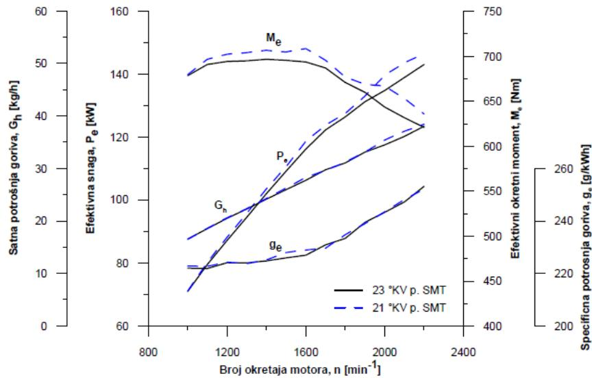
Slika 17. Performance motora pri korištenju biodizelskog goriva s kutom ubrizgavanja od  $21^\circ$  i  $23^\circ$  KV prije GMT
