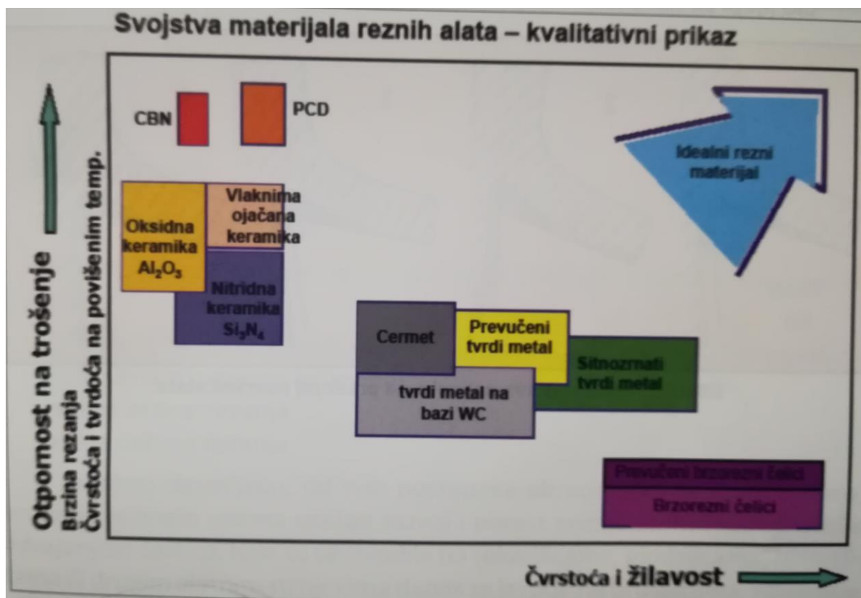
Slika 21 Podjela reznih materijala prema osnovnim svojstvima
