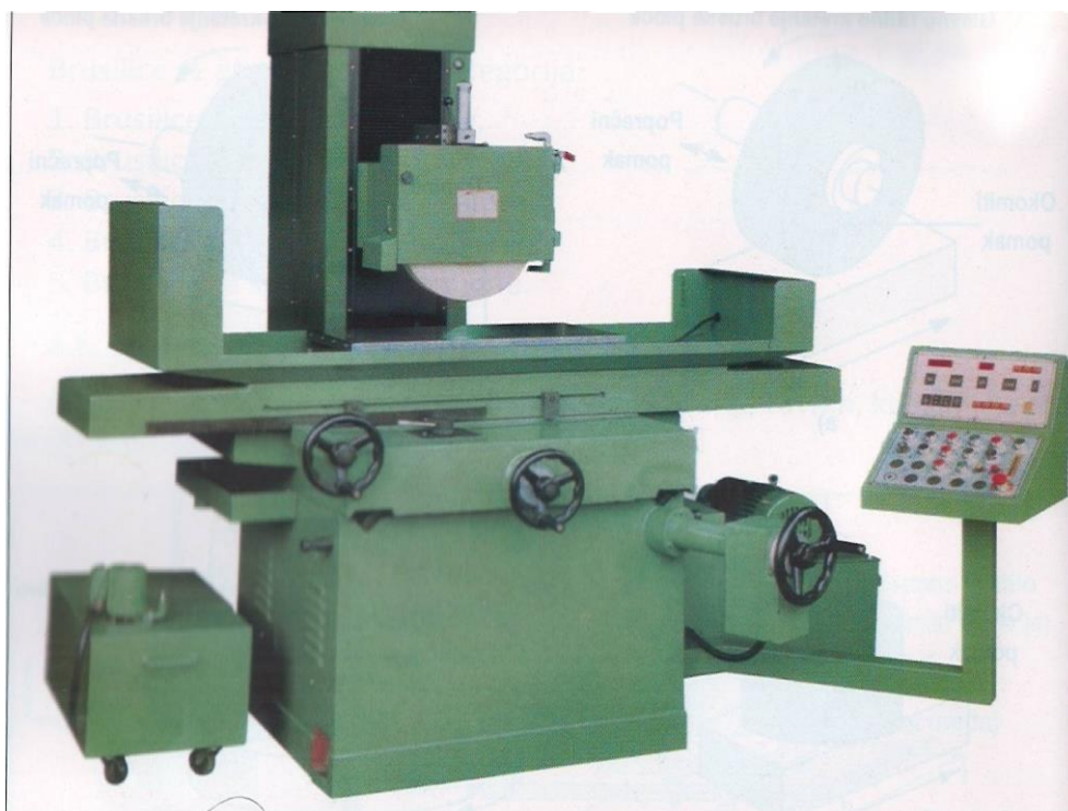
Slika 26 Brusilica za obodno plošno brušenje s uzdužnim stolom
