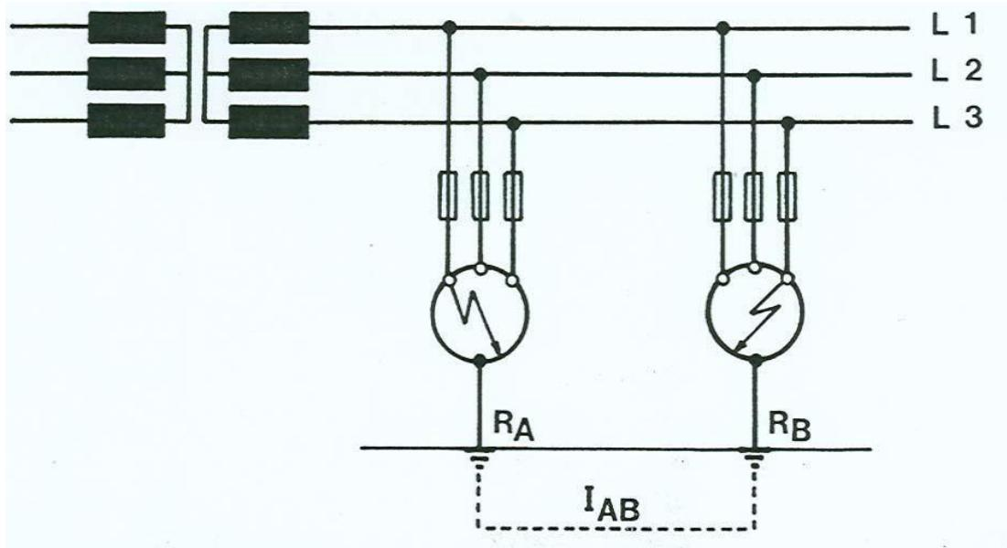
Slika 2.9. Predodžba dva istodobna zemljo-spoja u IT sustavu s pojedinačnim uzemljivačem.
