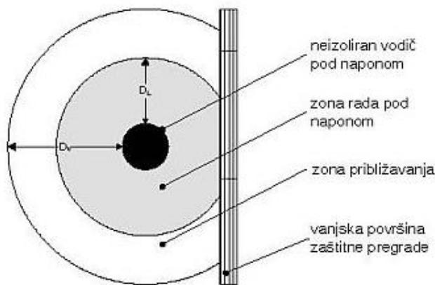
*Slika 4.5. Predodžba ograničavanja zone rada pod naponom zaštitnim izolacijskim pregradama.*
