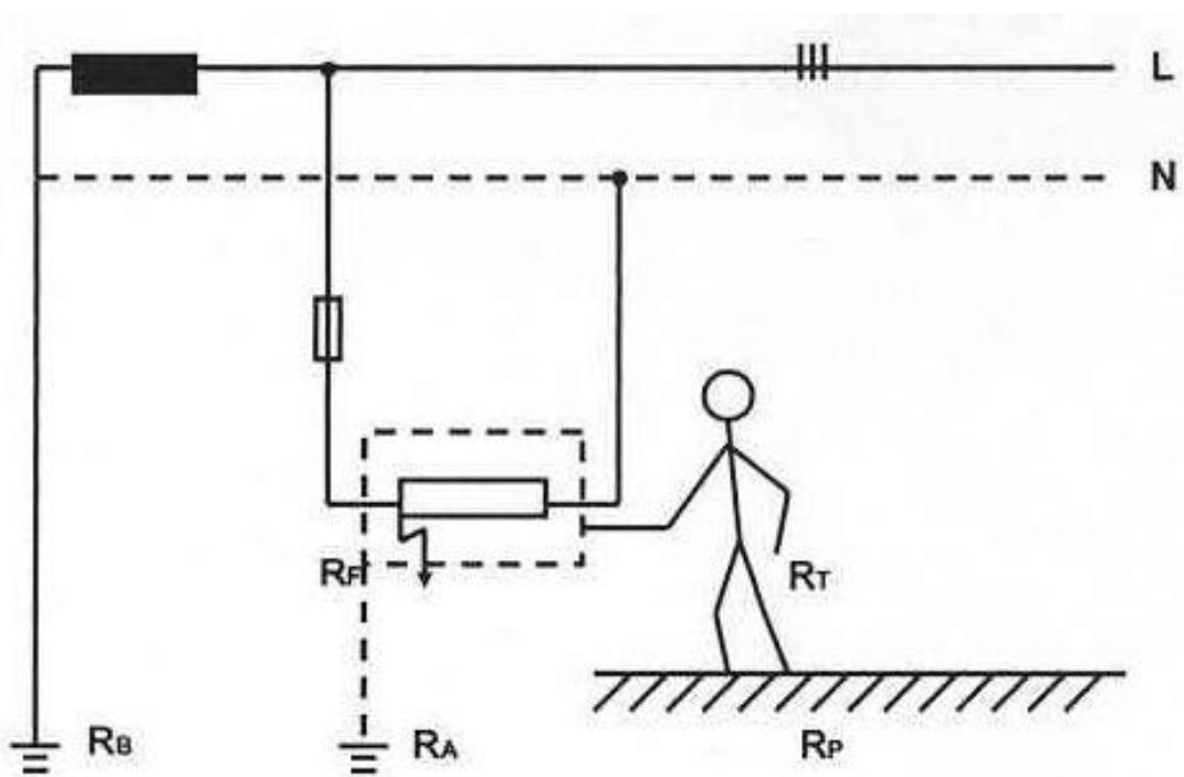
Slika 2.6. Predodžba: Napon dodira pri vodljivom tlu. Izvor:
