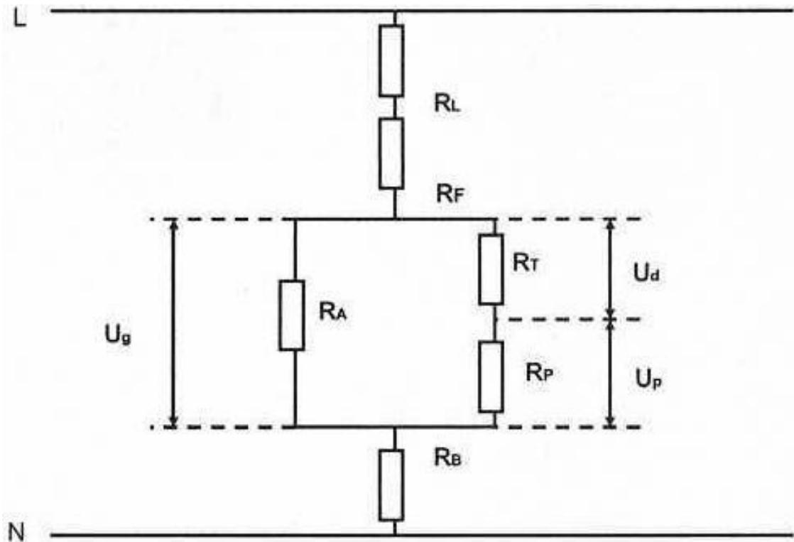
Slika 2.7. Predodžba: Nadomjesna shema petlje kvara. Izvor:
