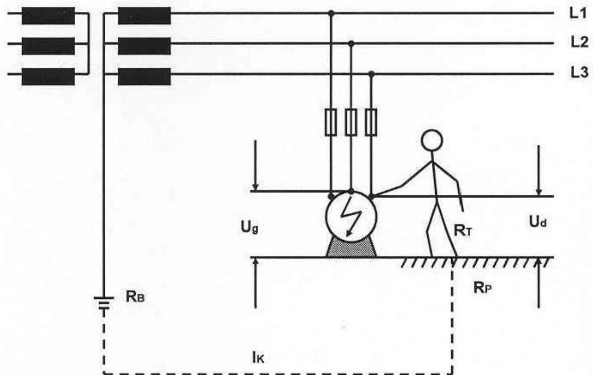
Slika 2.5. Predodžba: Dodir kućišta trošila kod probroja izolacije vodiča.
