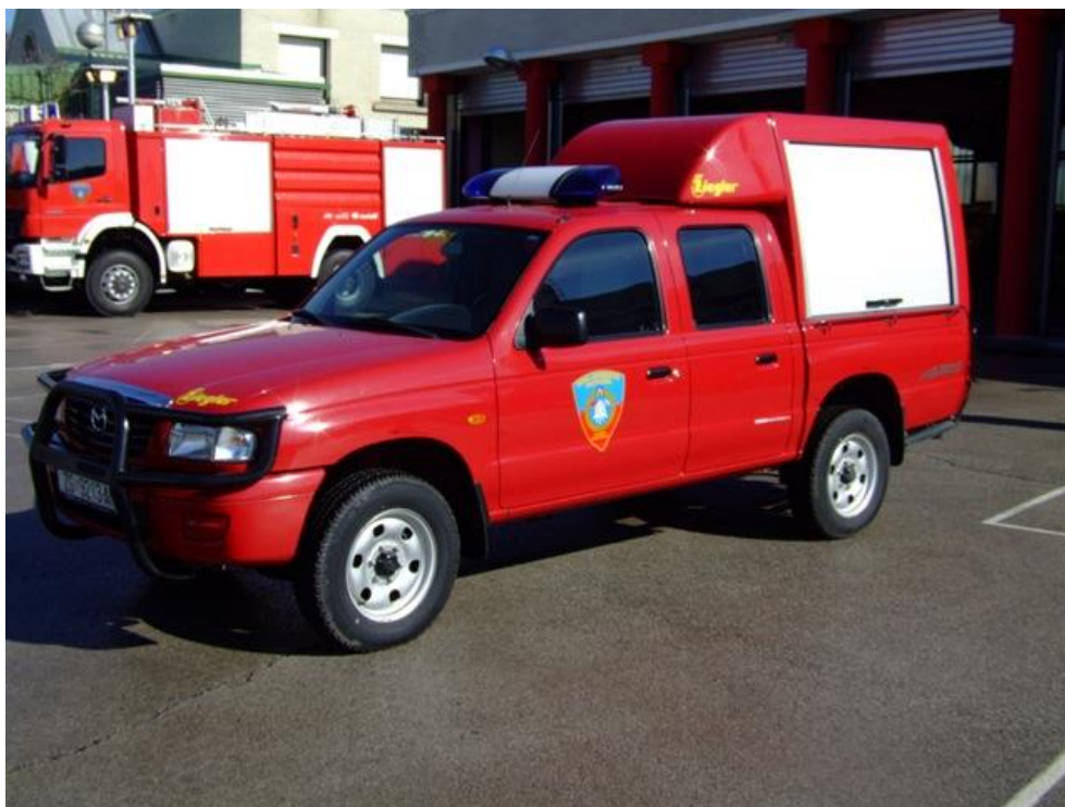
Slika 1. Tehničko vozilo malo za prijevoz 5 vatrogasaca s agregatom za struju i alatom za otvaranje stanova [3]
