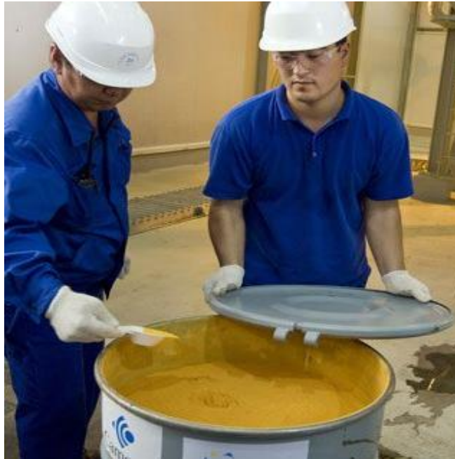
Sl. 15 Uranov koncentrat u standardnoj 200-litarskoj bačvi
