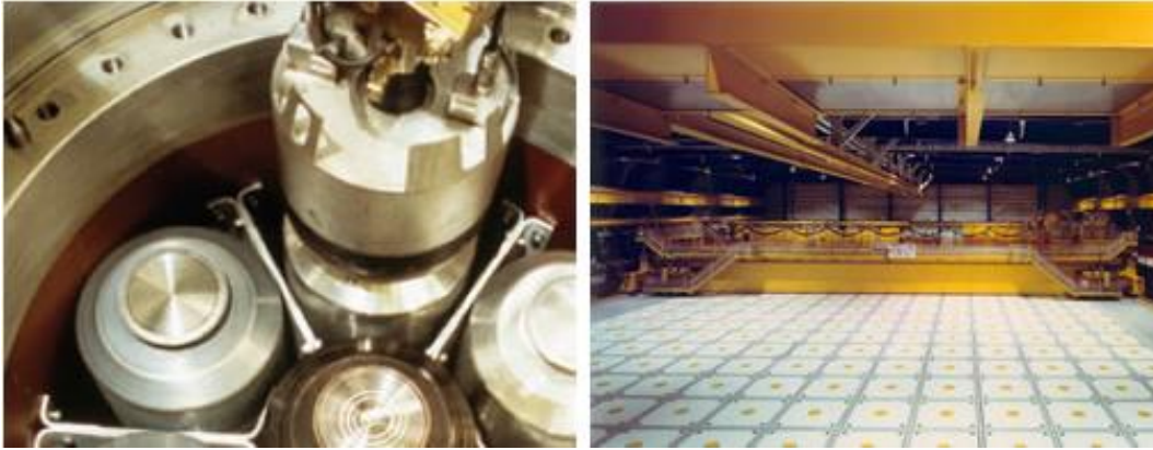
Sl. 8 Spremnici s vitrificiranim materijalom
