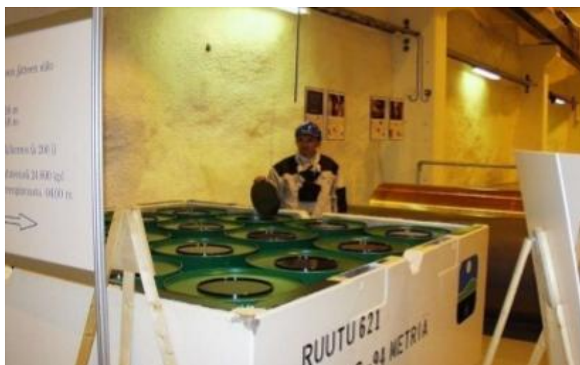
Sl. 20 Kontejner sa spremnicima za radioaktivni otpad u odlagalištu Olkiluoto, Finska
