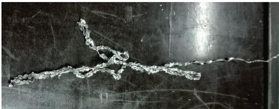
Slika 42. Odvojena čestica nakon 11. provrta
