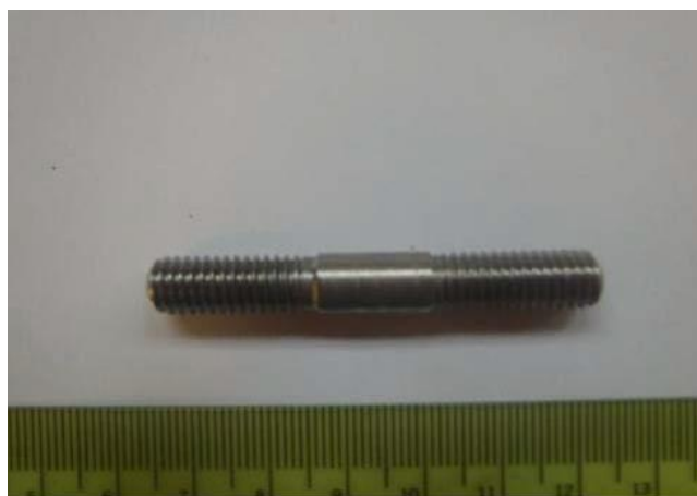
Slika 32. Implant uzorak s obostranim navojem[35]
