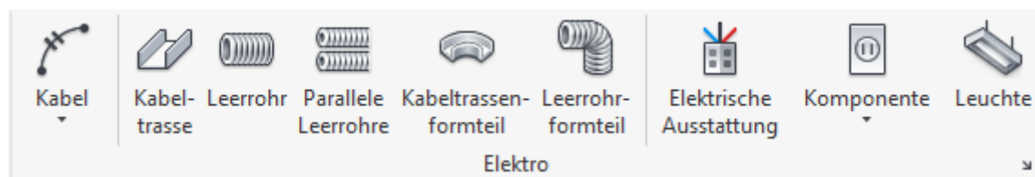
Slika 17. Predefinirani elementi za elektro instalacije
