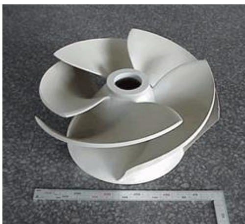
Slika 15. Ventilator izrađen SLS 3D printerom [48]
