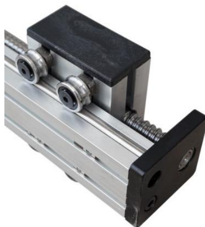
Slika 43. Vodilica aktuatora Z-osi. [66]
