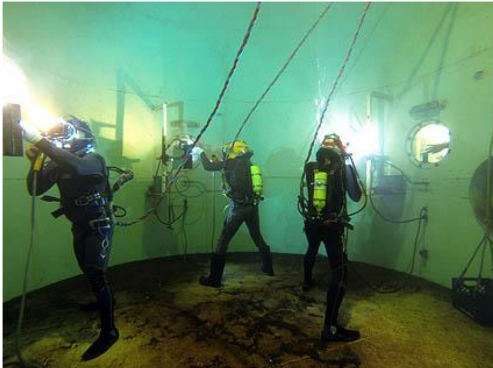
Slika 28. Obuka zavarivača u kontroliranim uvjetima bazena [24]
