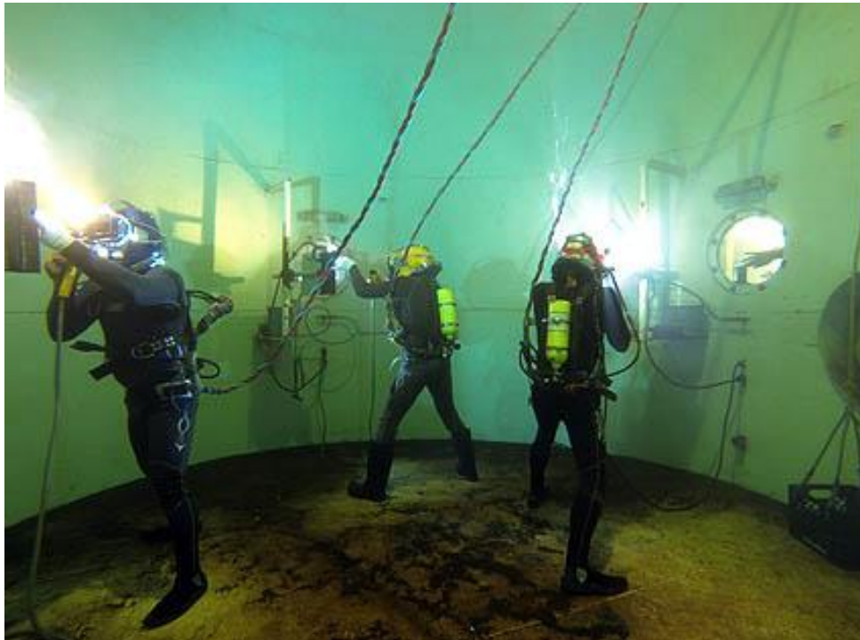
Slika 28. Obuka zavarivača u kontroliranim uvjetima bazena [24]
