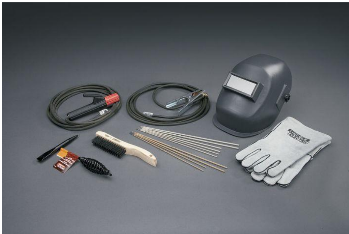
Slika 9. Vodič, stezaljka za masu, držač elektrode, zaštitna sredstva i pomoćni alati [11]
