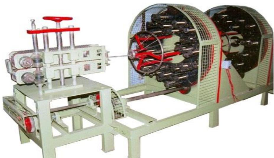
**SLIKA 7.** Horizontalni stroj za pletenje užeta [7]
