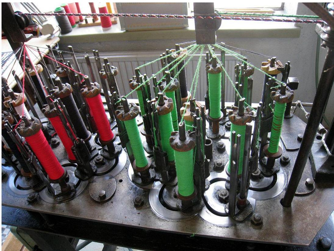
**SLIKA 11. Spiralni stroj za pletenje [11]**
