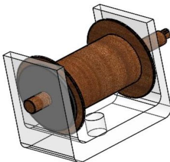
**SLIKA 35.** 3D model modeliranog i spojenog sklopa bubnja
