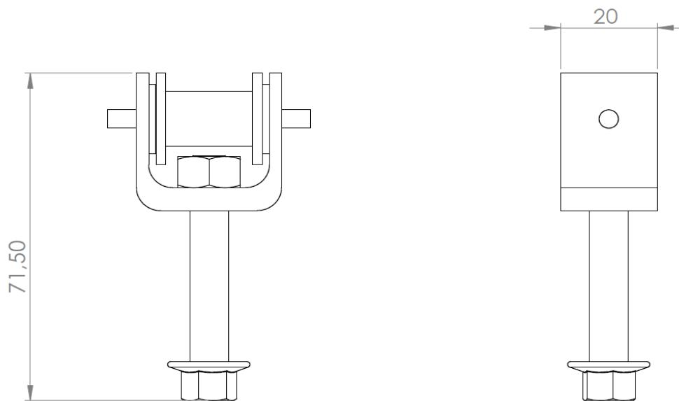
**SLIKA 25.** Načrt i bokocrt spojenog držača špule
