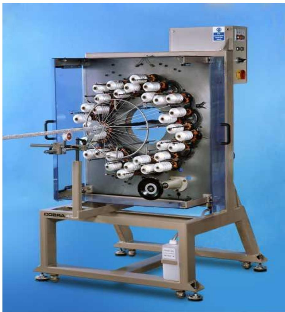
**SLIKA 12. Horizontalni stroj s 32 špule [12]**
