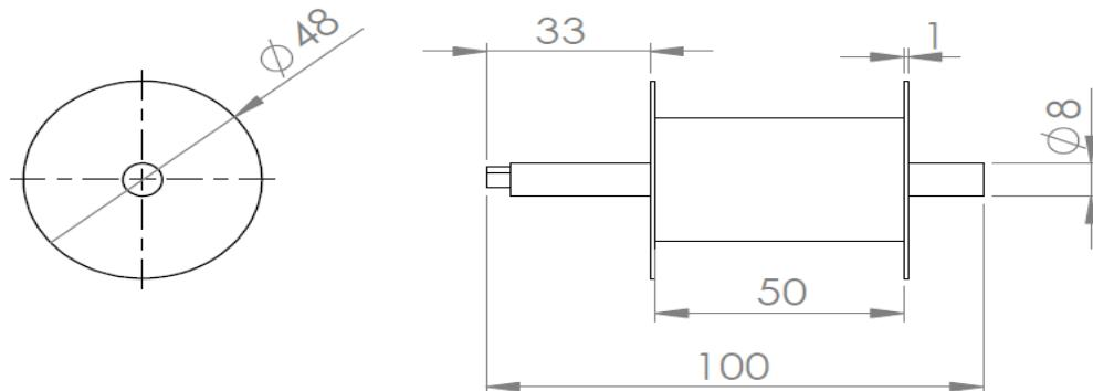
**SLIKA 30.** Nacrt i bokocrt bubenja s osnovnim dimenzijama
