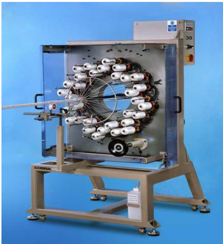
SLIKA 12. Horizontalni stroj s 32 špule [12]
