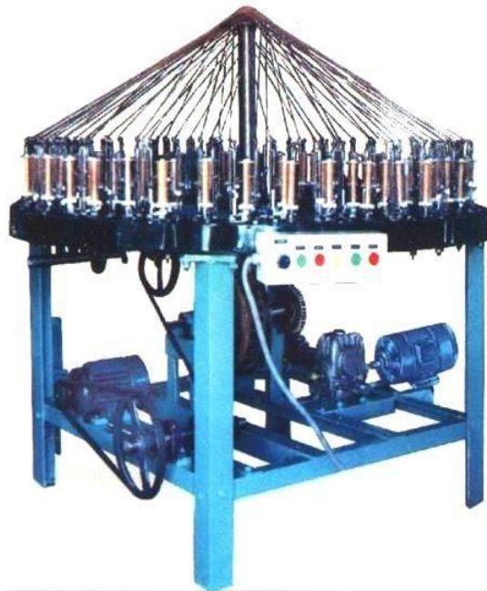
**SLIKA 6.** Vertikalni stroj za pletenje [6]
