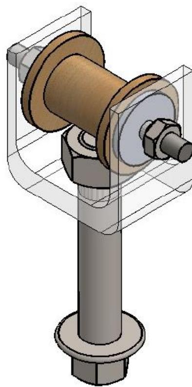
**SLIKA 26.** 3D model držača špule sa pričvršćenim maticama sa strane iz Solidworks-a
