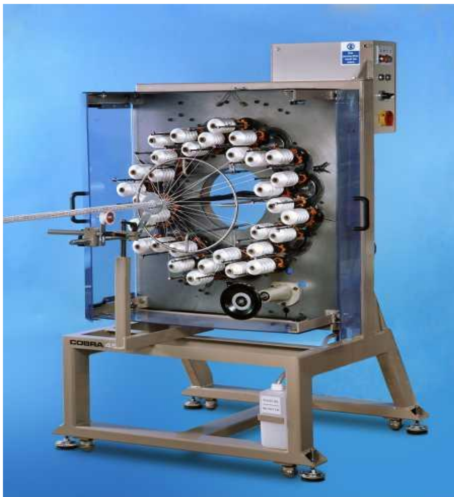
SLIKA 12. Horizontalni stroj s 32 špule [12]
