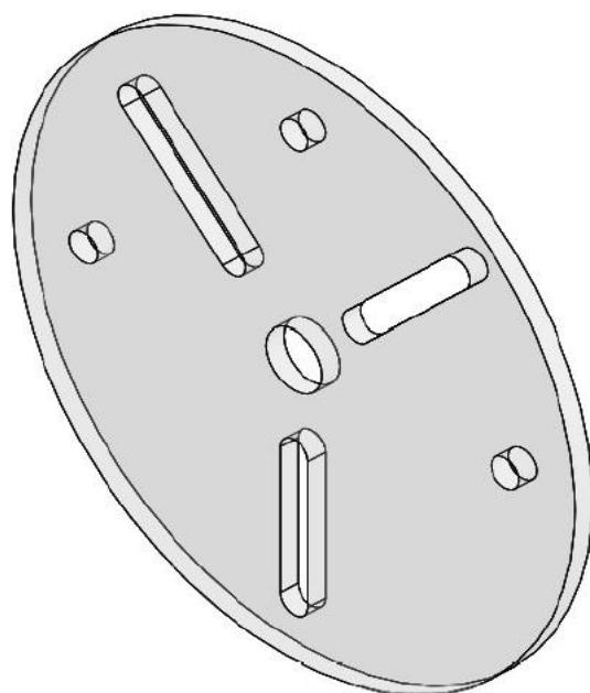
**SLIKA 29.** 3D model diska iz Solidworks-a
