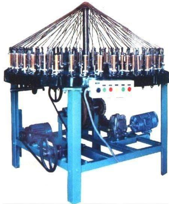
SLIKA 6. Vertikalni stroj za pletenje [6]
