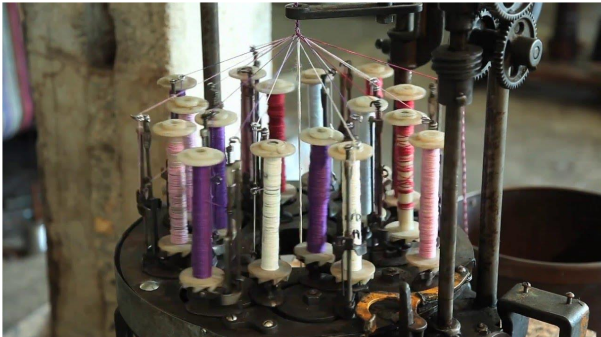
SLIKA 9. „MAYPOLE“ stroj za pletenje [9]
