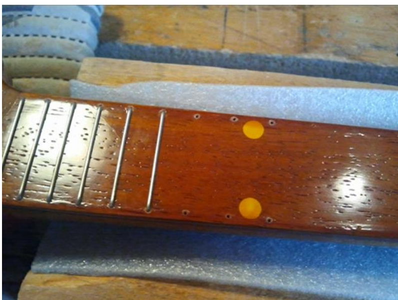
Slika 25. Izrada kota (pragova) čeličnom žicom [14]
