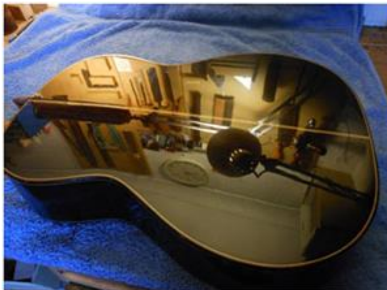
Slika 28. Površina obrađena šelakom [16]
