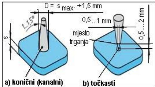
Slika 74: Konični i točkasti uljevak
