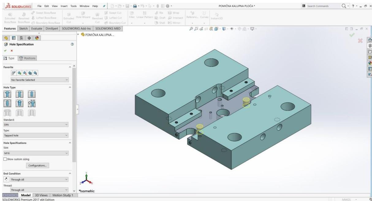
Slika 119: Hole Wizard kod izrade kalupnih ploča
