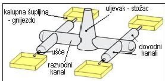
Slika 72: Uljevni sustav sa četiri glijezda
