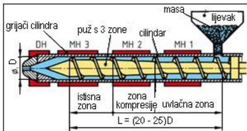
Slika 62: Pužno-klipni extruder
