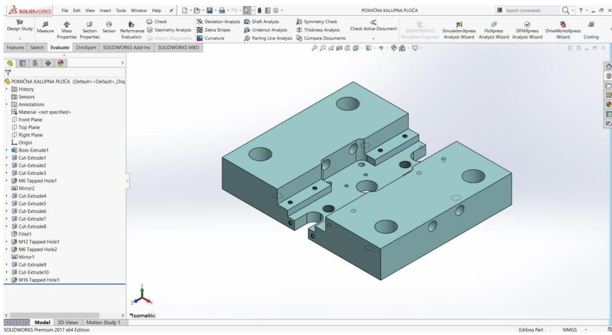
Slika 118: Model kalupne ploča
