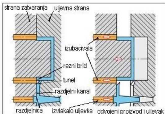
**Slika 80: Tunelski uljevak**
