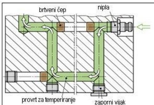
Slika 107: Izvedba kanala za temperiranje
