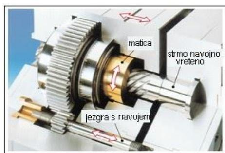
Slika 104: Navojno vreteno sa zupčanicima za okretanje i izvlačenje jezgre s navojem
