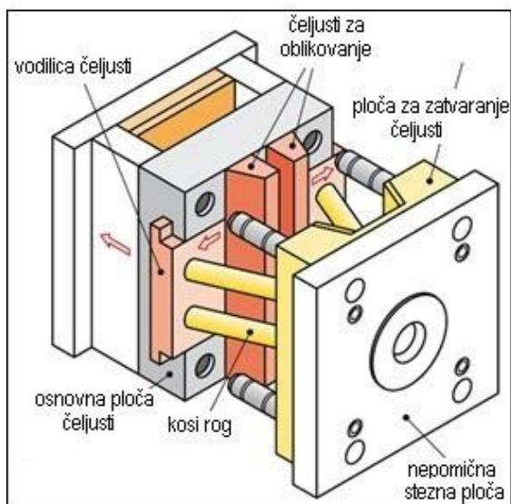
Slika 100: Kućište alata sa čeljustima
