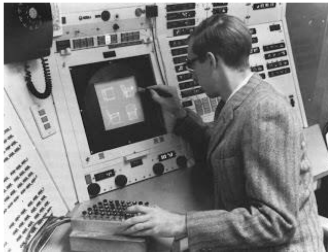
Slika 2:Sketchpad sustav na konzoli TX-2 u MIT-u(1963)
