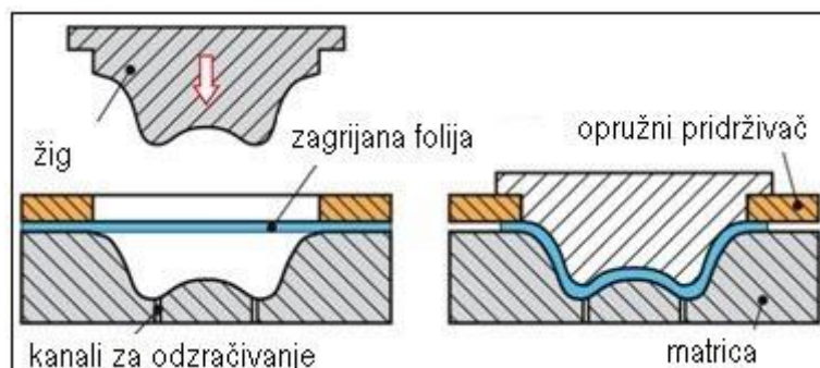
Slika 44: Alat za duboko vučenje sa matricom
